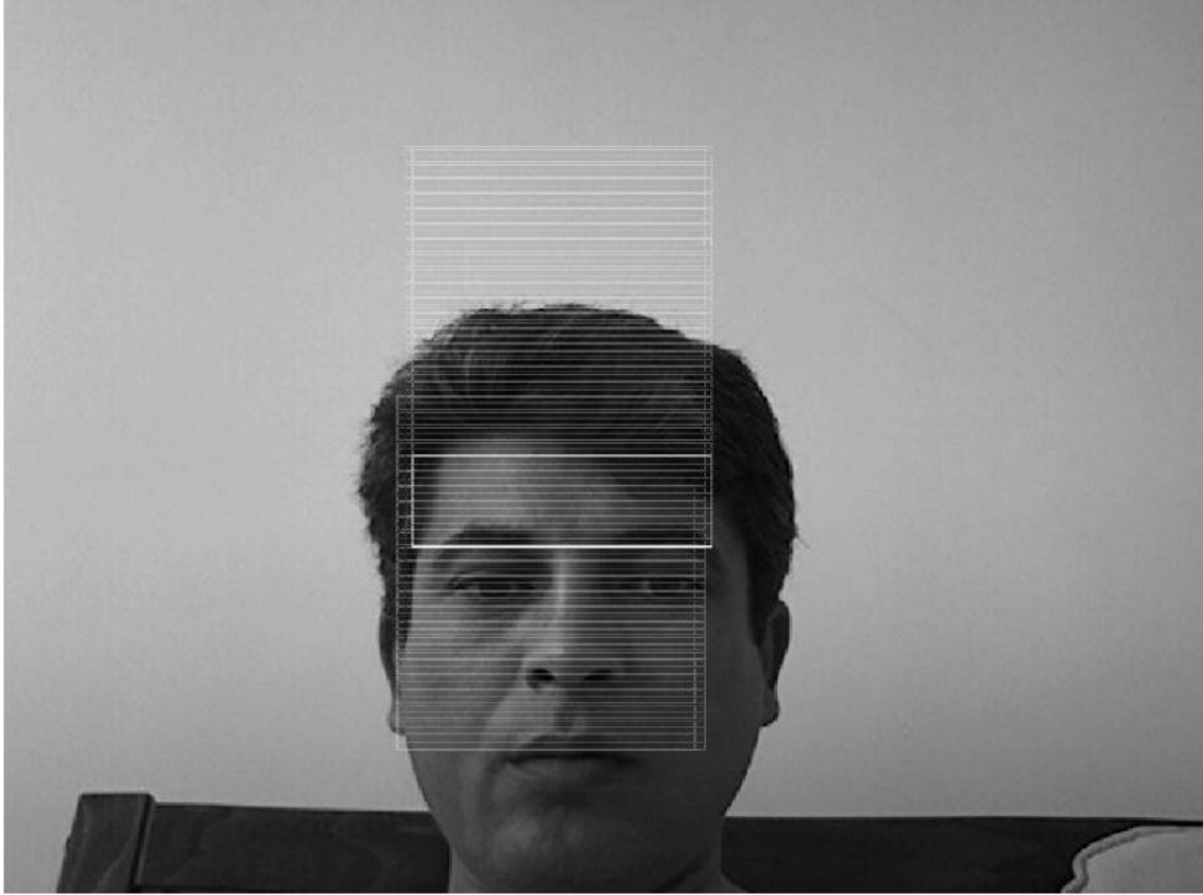
Şekil 4.6. Test aşamasında YSA ile tarama usulüne göre göz bölgesinin bulunması
