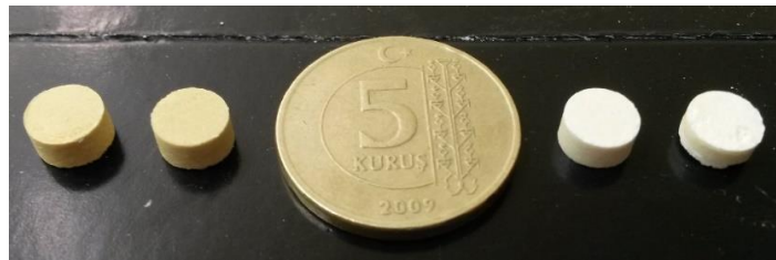
Şekil 4.5. Sinterlenmiş IMF ve ThO 2 peletlerinin görüntüsü
