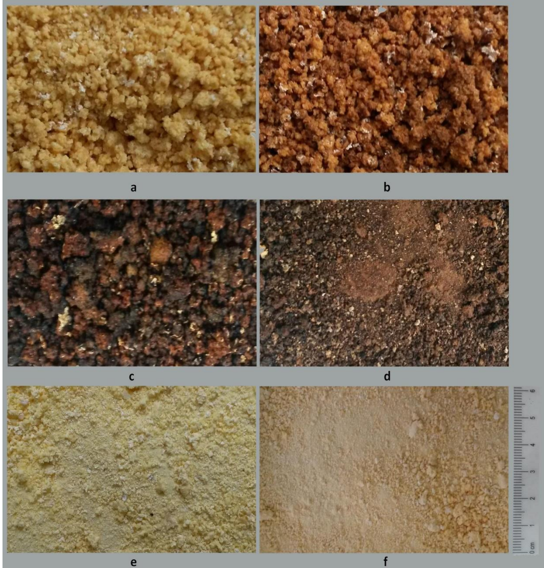
Şekil 4.4. Sol-gel metodu ile elde edilen jelin a) 50, b) 100, c) 150, d) 350, e) 500, f) 1000 °C'de işlem görmüş toz halinin makro görüntüleri
