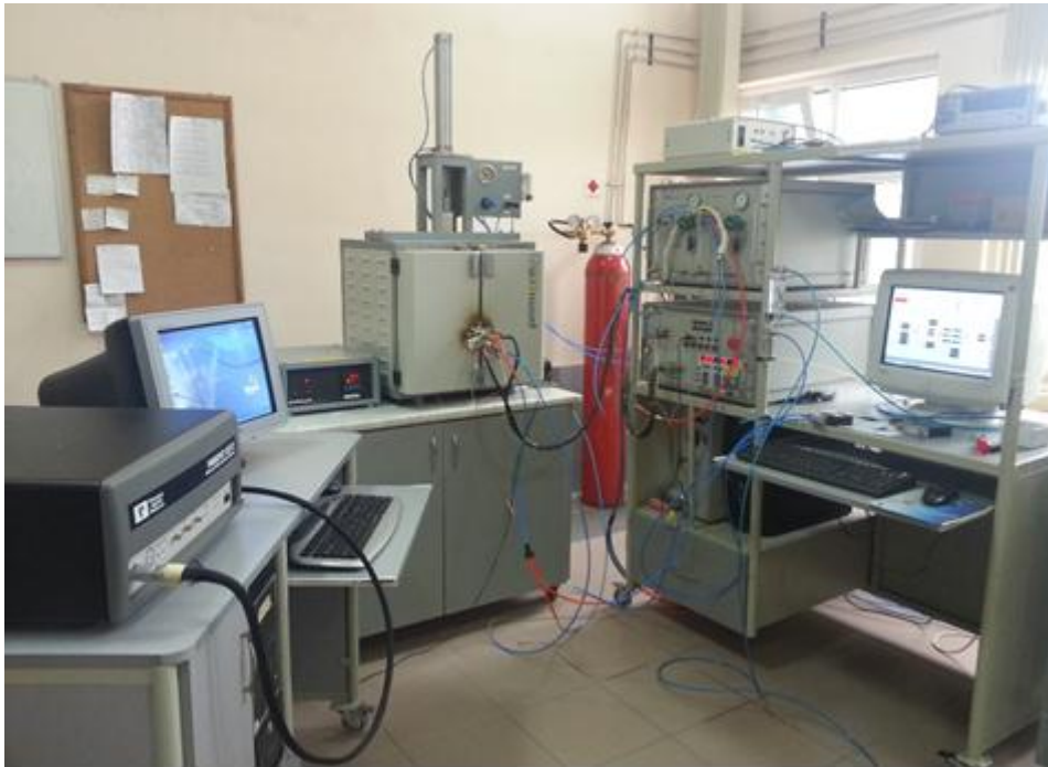
Şekil 5.3. Katı oksit yakıt pili test düzeneği
