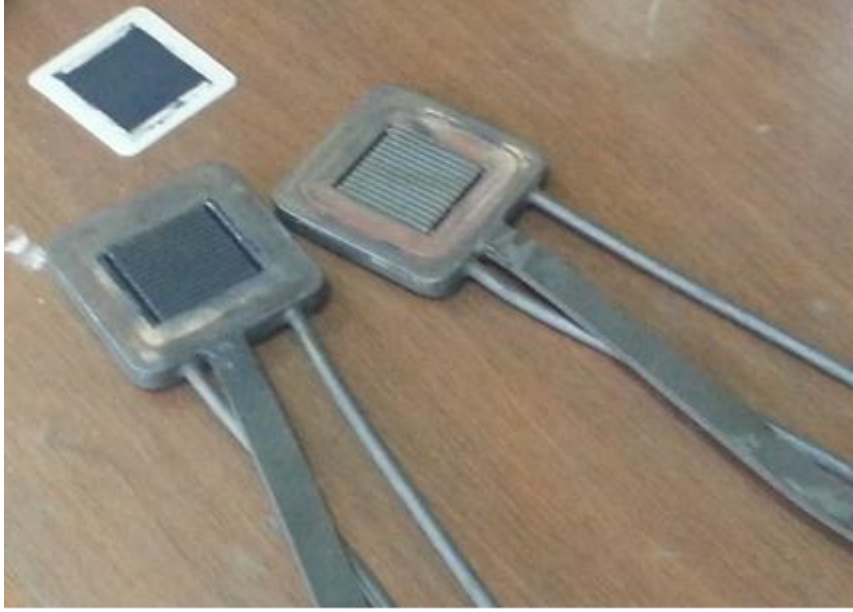
Şekil 5.1. Katı oksit yakıt pili katot, anot ve elektrot grubu
