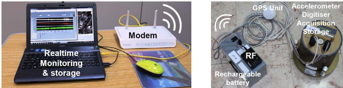
Şekil 3.2. AREL DAC-3HDG serisi ivmeölçer ve kullanılan ölçüm ağı
