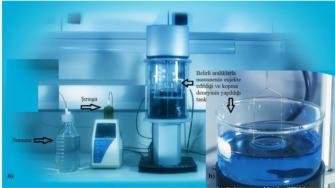
Şekil 5.88. a) Yüze gerilim tayin cihazı bölümleri b) Kopma deneyinin yapıldığı tank
