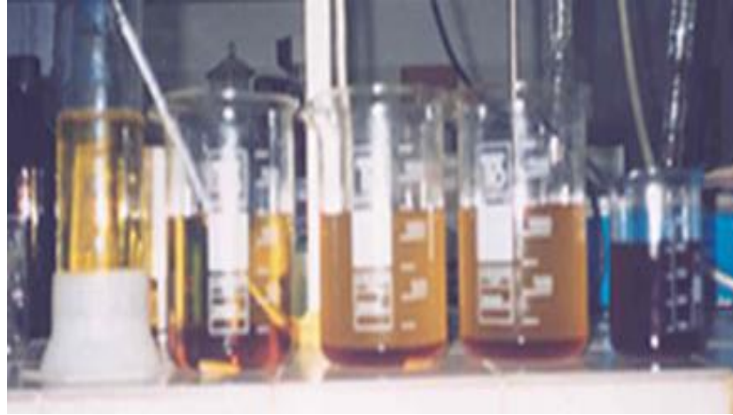
Şekil 3.1. Üretilen esterler ve gliserin tabakasının çökelti olarak oluşumu
