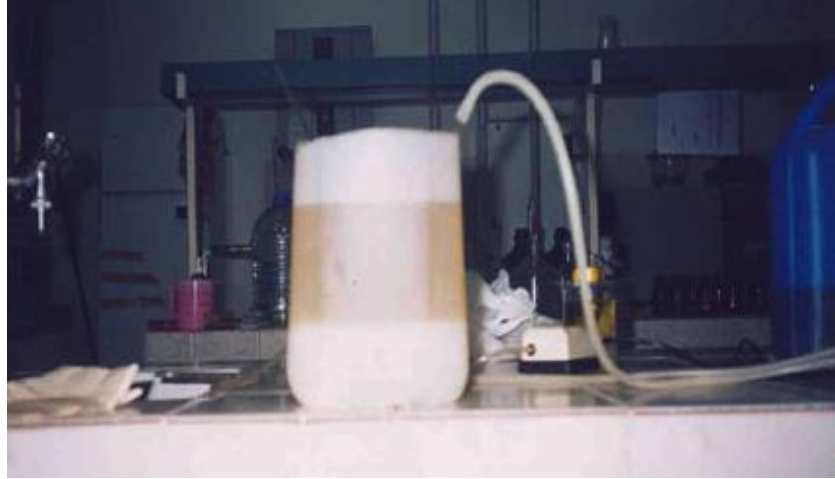
Şekil 3.2. İlk yıkama sonrası ester tabakası ve beyaz renk almış su tabakasının görünümü
