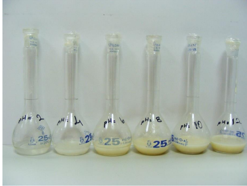
Şekil 4.1. Değişik pH'larda hegzan ile ekstrakte edilen biyodizel atıksuyunun ekstraksiyondan sonraki durumları
