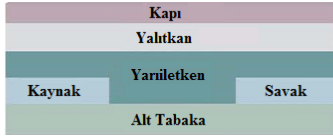
Şekil 2.13. Weimer ve arkadaşları tarafından incelenen Üst Kapı TFT [114].
