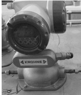
Şekil 5.7. Deneysel otomobil klima sisteminde kullanılan Coriolis tip kütle akış sensörü.
