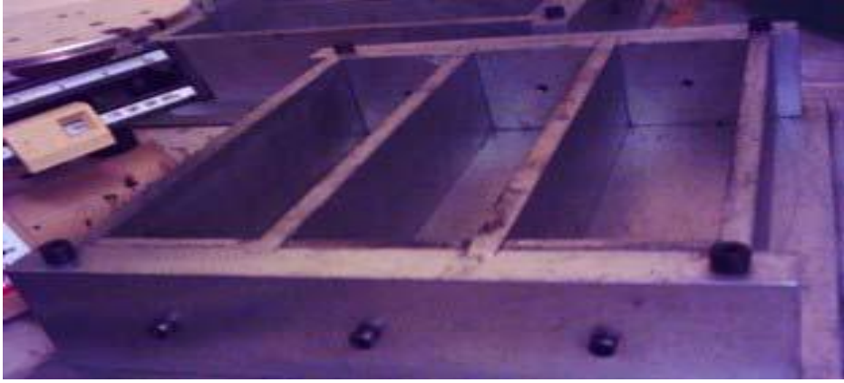
Şekil 6.33. 75×75×285 mm boyutlarında harç kalıpları
