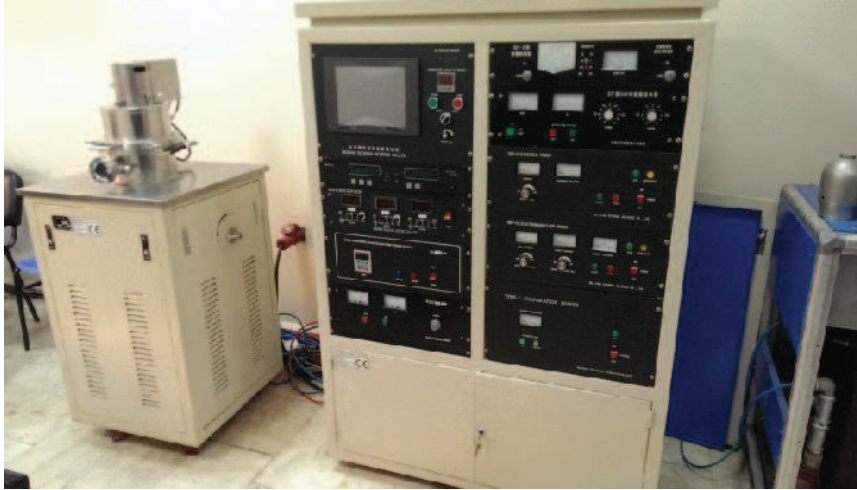
Şekil 6.1. Çok fonsiyonlu ince film kaplama makinası
