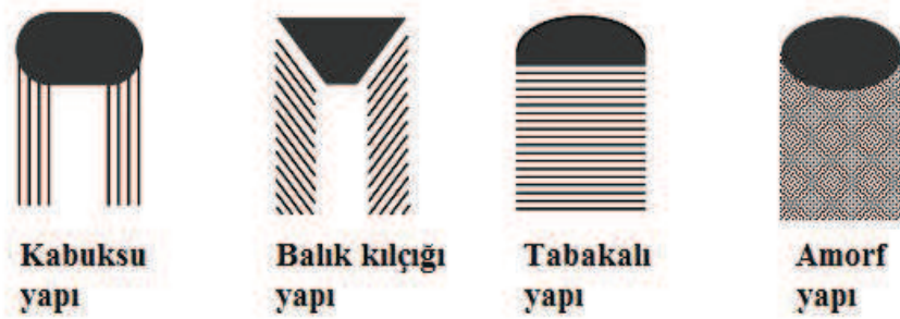
Şekil 5.4. Karbon nanofiber büyümesi kesitinin şematik gösterimi [66]
