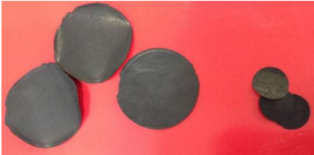
Şekil 5.2. Membrandan sıyrılmış ÇDKNT kağıtlar (solda) ve serbest elektrot olarak kullanılmak üzere 16 mm çapında kesilmiş ÇDKNT kağıt altlıklar (sağda)
