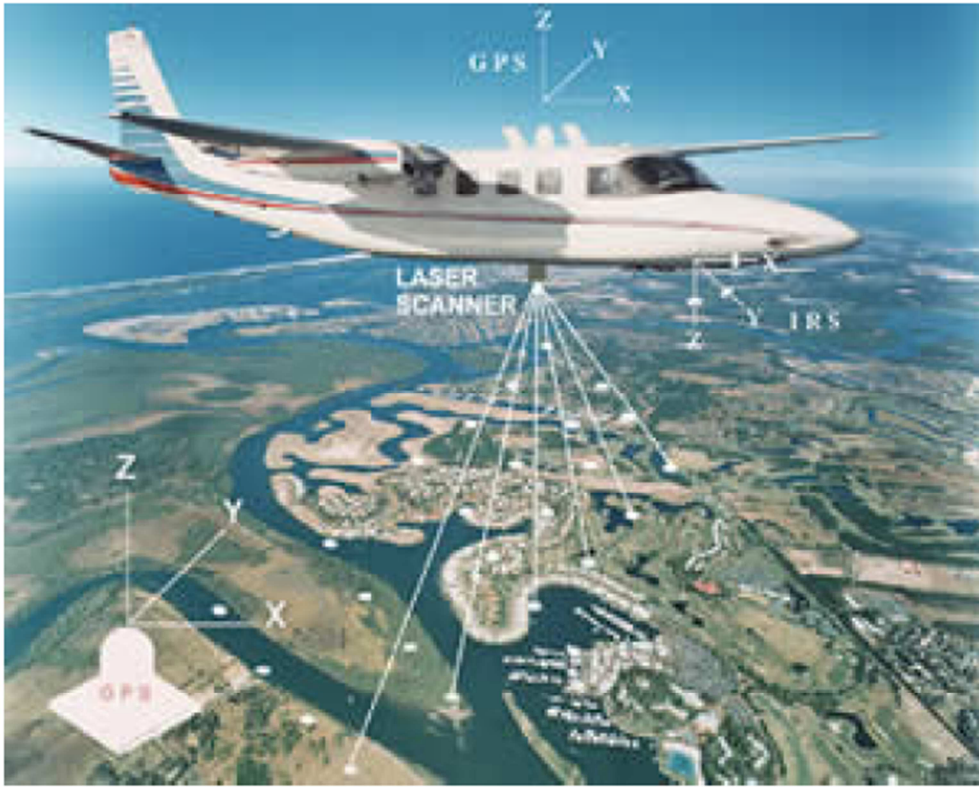
Şekil 3.1. Lidar veri toplama yöntemi
