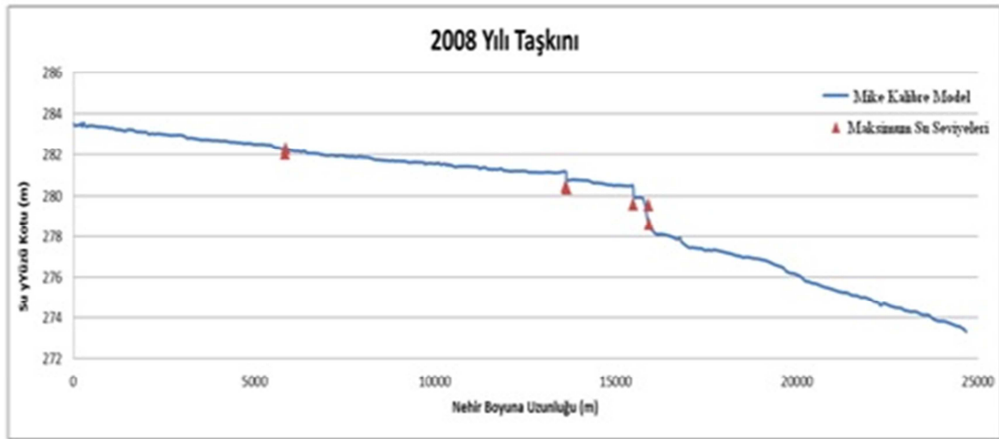
Şekil 5.52. Kalibre edilmiş model su yüzü profili
