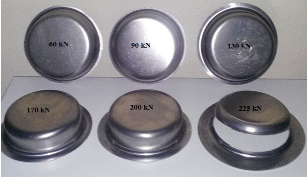
Şekil 6.3. Farklı BPK'lerinde yapılan çekme deneyi.
