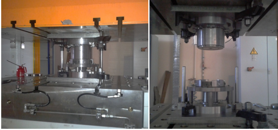
Şekil 4.11 Tasarlanmış deney düzeneğinin hidrolik prese montajı.
