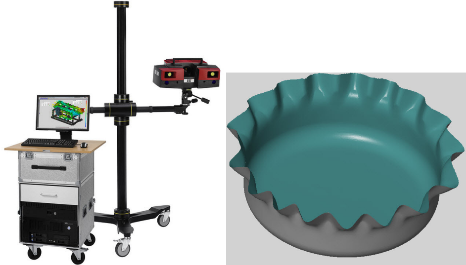
Şekil 4.13. Atos Optik Ölçüm Sistemi ve Derin Çekme Deney Sonucunun Sayısallaştırılmış Şekli (Deney 14).
