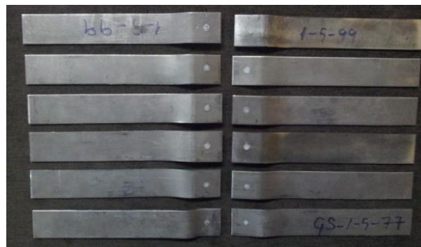
Şekil 5.5. SPA-C bağlantılarda 5 periyot kaynak zamanında oluşan çekme-sıyırma numuneleri
