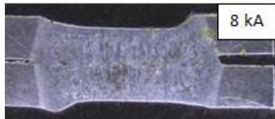
Şekil 5.95. S235JR(Cu) bağlantılarda 30 periyot kaynak zamanına ait makroyapı fotoğrafı
