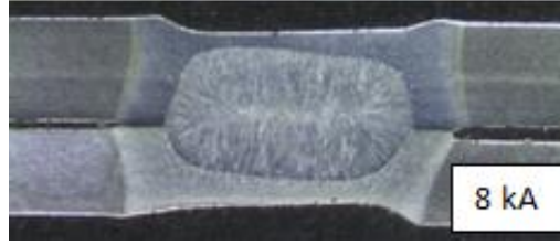
Şekil 5.91. SPA-C bağlantılarda 20 periyot kaynak zamanına ait makroyapı fotoğrafı
