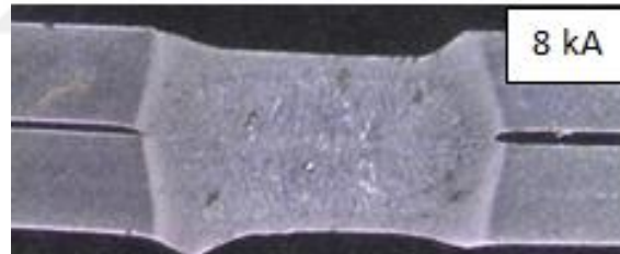
Şekil 5.94. S235JR(Cu) bağlantılarda 25 periyot kaynak zamanına ait makroyapı fotoğrafı
