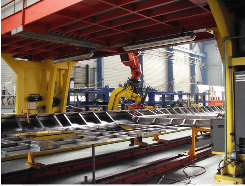
Şekil 3.2. Raylı sistem aracı yan duvar kaynak hattı
