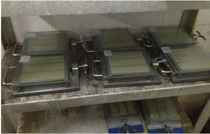
Şekil 3.5. %90 Bağıl nemde ve 20 °C sıcaklıkta kalıpta 1 gün bekletilen harç numuneleri
