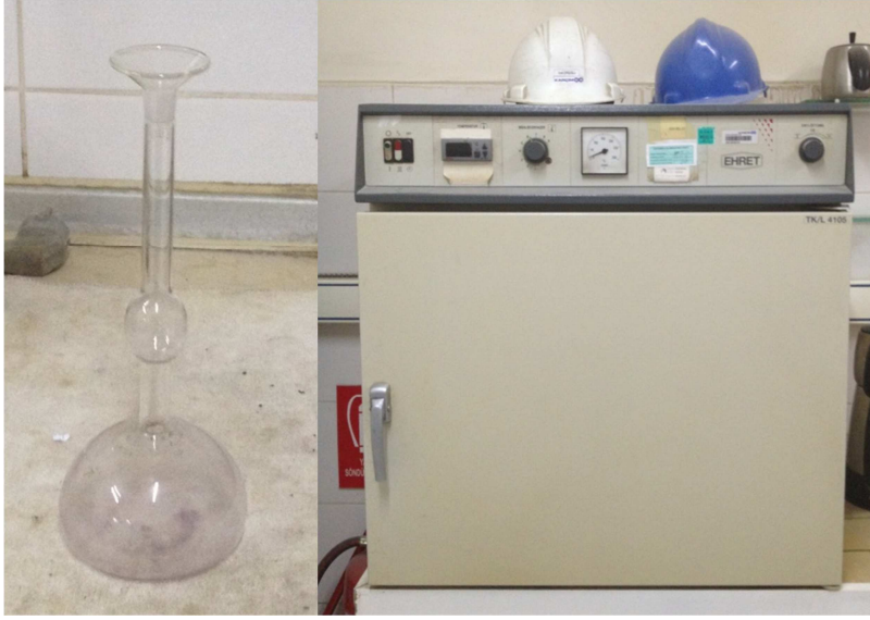
Şekil 3.11. Le-chatelier şişesi ve etüv aleti
