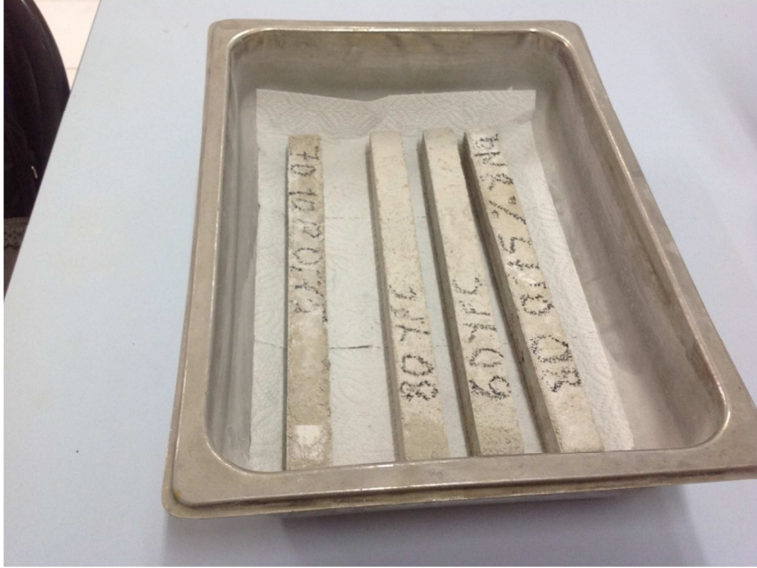
Şekil 3.65. Kuruma büzülmesi deneyi için üretilen numuneler
