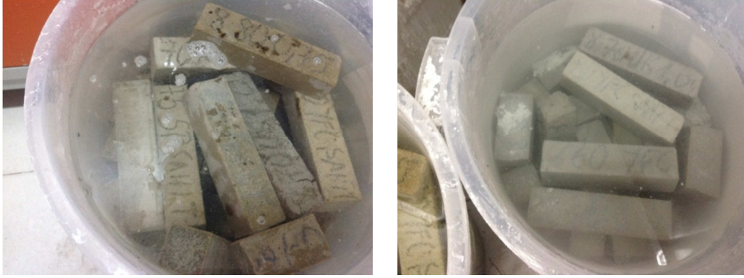
Şekil 3.60. Sülfatlı sularda bekletilen numuneler
