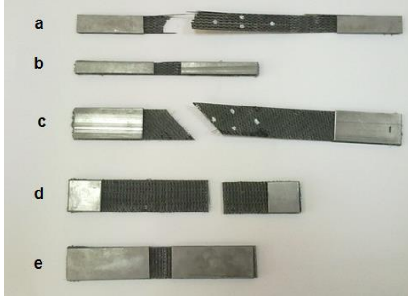
Şekil 6.23. Tek eksenli (enlemesine ve boylamasına) karbon elyaf takviyeli kompozitlerin çekme, basma ve kayma deneyleri sonrası hasar görüntüleri a) boylamasına çekme deneyi, b) boylamasına basma deneyi, c) tek eksenli (45° yönelmiş) kayma deneyi, d) enlemesine çekme deneyi, e) enlemesine basma deneyi
