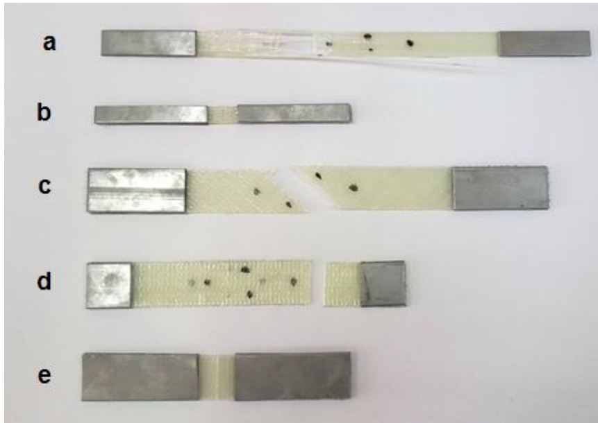
Şekil 6.22. Tek eksenli (enlemesine ve boylamasına) cam elyaf takviyeli kompozitlerin çekme, basma ve kayma deneyleri sonrası hasar görüntüleri a) boylamasına çekme deneyi, b) boylamasına basma deneyi, c) tek eksenli ( 45^\circ yönlendirilmiş) kayma deneyi, d) enlemesine çekme deneyi, e) enlemesine basma deneyi
