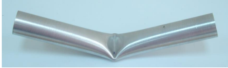
Œekil 6.29. Eęme deneyi sonrası tp kiriŒin grnm
