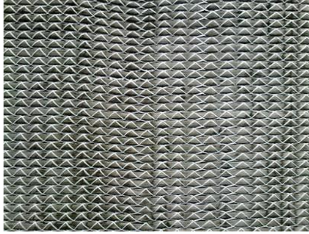
Şekil 5.3. 350 g/m 2 0° (ve 90° sarıma bağlı) tek eksenli karbon elyaf
