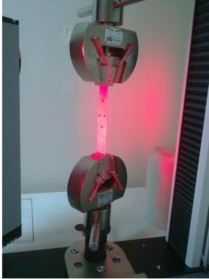
Şekil 5.21. Cam elyaftan hazırlanan çekme numunesine çekme deneyinin uygulanışı
