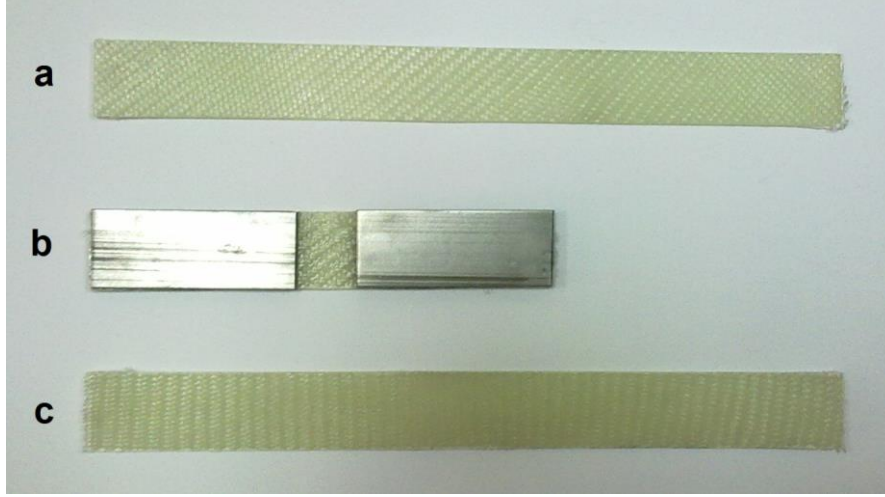
Şekil 5.16. Cam dokuma elyaftan hazırlanan deney numuneleri a) çekme numunesi (en:25 mm, boy: 250 mm, kalınlık: 2.5 mm), b) basma numunesi (en:25 mm, boy: 150 mm), c) kayma numunesi (en:25 mm, boy: 250 mm, kalınlık: 2.5 mm)
