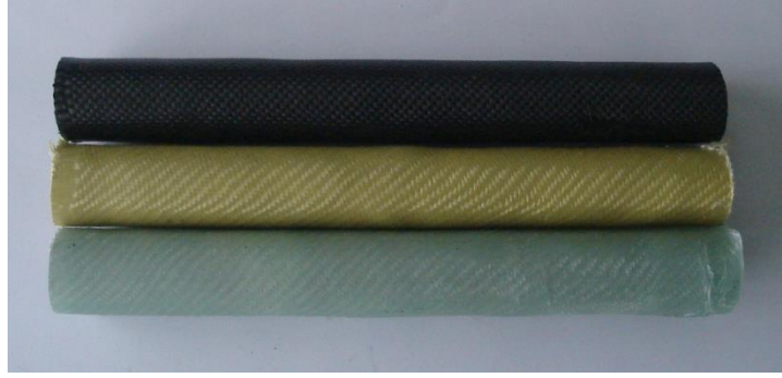
Şekil 5.28. Çapı 30 mm olan alüminyum tüpte dokuma şeklindeki karbon, aramid ve cam elyaf kullanılarak oluşturulan kompozit kiriş yapılara ait eğme deneyi numuneleri
