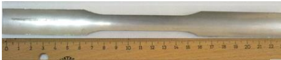
Şekil 5.12. Çapı 31 mm olan alüminyum borudan çıkartılan çekme numunesi
