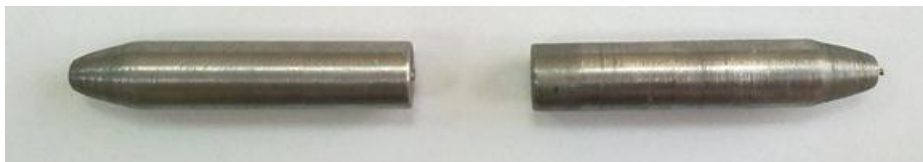
Şekil 5.7. Çapı 19 mm ( t=1 mm) olan alüminyum tüp giriş için hazırlanan tapalar
