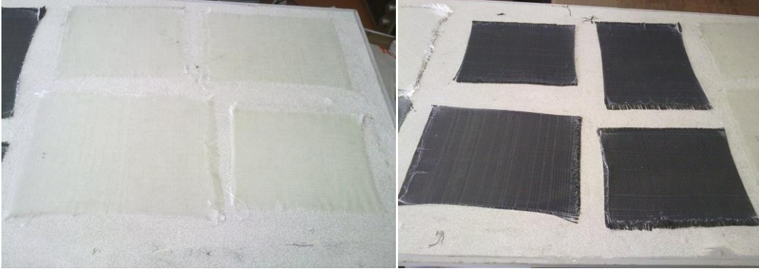
Şekil 5.15. Deney numunelerinin elle yatırma yöntemiyle düz zemin üzerinde hazırlanışı
