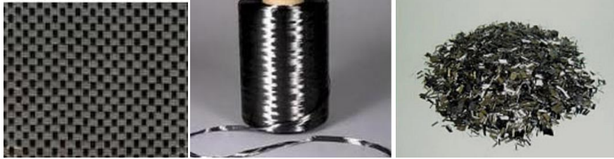
Şekil 2.4. Karbon elyaf çeşitleri a) Dokuma elyaf b) Fitol elyaf c) Kırpıntı elyaf [56]
