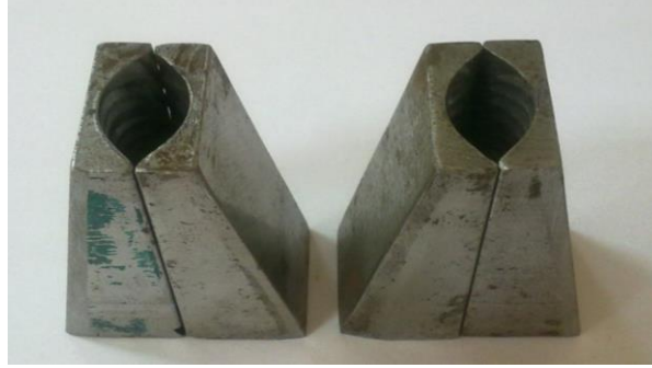
Şekil 5.9. 19 mm çaplı borunun çekme deneyi için hazırlanan çeneleri
