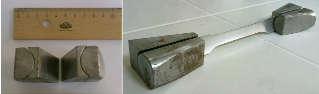
Şekil 5.13. Çekme çenesi (a) ve numunenin yerleştiriliş şekli (b)
