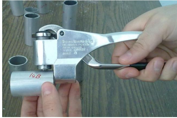
Şekil 5.1. Alüminyum borudan alınan kuponlar üzerinden Webster sertlik ölçme el aleti
