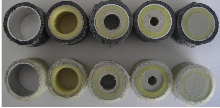
Şekil 5.26. İçten (kestamit ve polipropilen) ve dıştan (cam ve karbon elyaf) takviye edilmiş D=31\text{ mm} t=1\text{ mm} olan alüminyum tüpler
