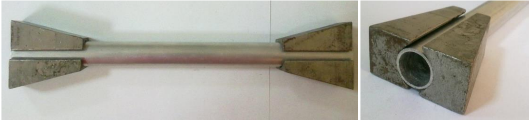
Şekil 5.10. Çenelerin boru çekme numunesine yerleştiriliş biçimi (tapasız)
