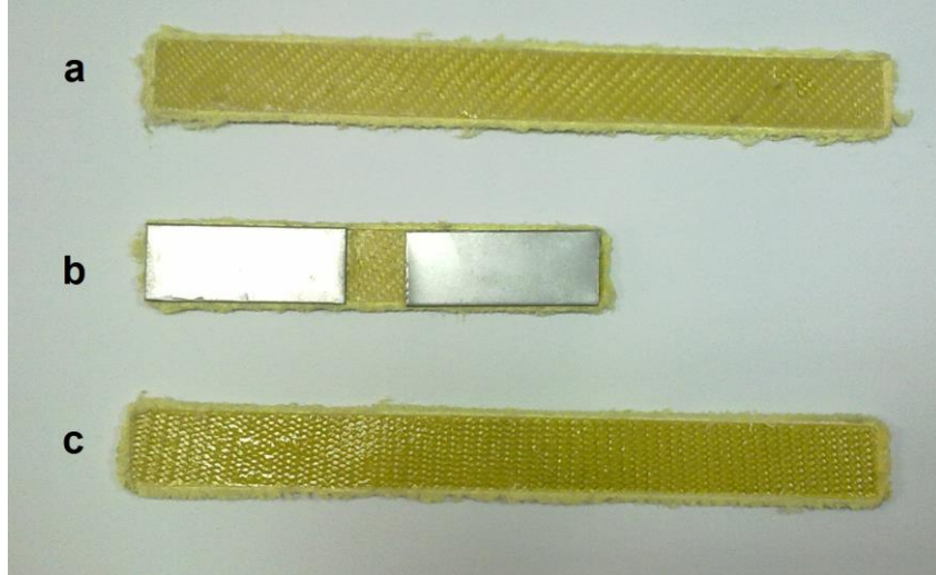
Şekil 5.17. Aramid dokuma elyaftan hazırlanan deney numuneleri a) çekme numunesi (en:25 mm, boy: 250 mm, kalınlık: 2.5 mm), b) basma numunesi (en:25 mm, boy: 150 mm), c) kayma numunesi (en:25 mm, boy: 250 mm, kalınlık: 2.5 mm)
