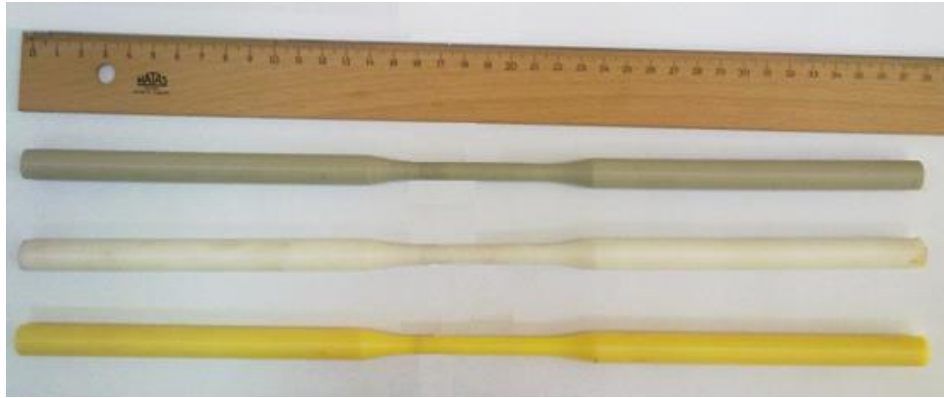
Şekil 5.14. Polimerik malzemelerden (kestamit, polyamit ve polipropilen) işlenmiş silindirik çekme numuneleri
