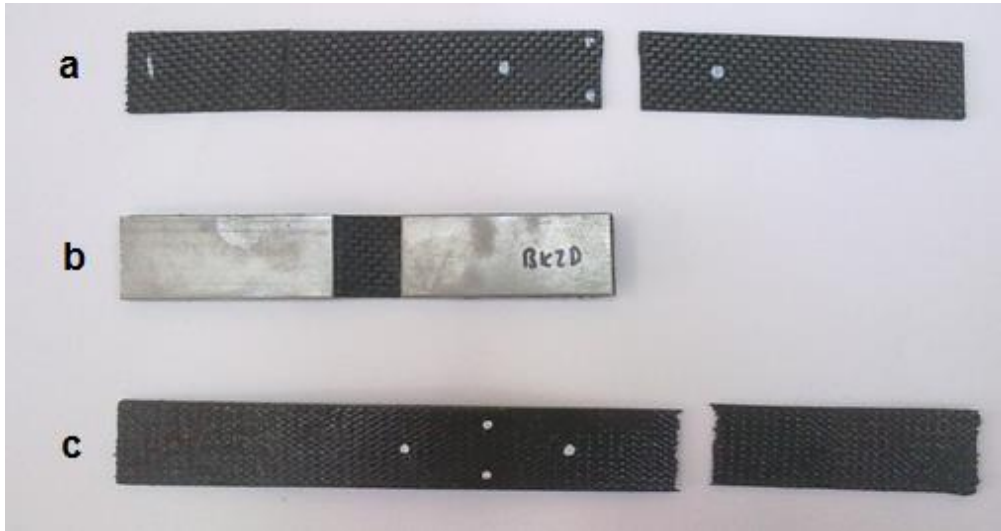
Şekil 6.20. Karbon dokuma elyaf takviyeli kompozitin çekme, basma ve kayma deneyleri sonrası hasar görüntüleri
