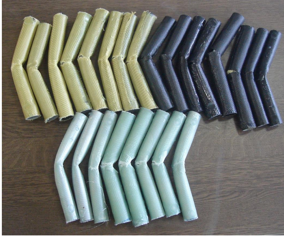
Şekil 6.54. 30 mm çaplı alüminyum tüp ile oluşturulan bir grup hibrit kompozit numunenin eğme deneyi sonrasına görüntüleri
