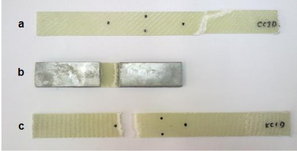
Şekil 6.19. Cam dokuma elyaf takviyeli kompozitin çekme, basma ve kayma deneyleri sonrası hasar görüntüleri
