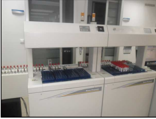
Şekil 3.1. Tüplerin sisteme giriş ünitesi
