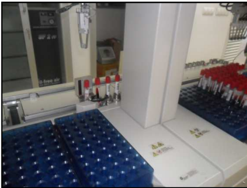
Şekil 3.3. Hatalı barkotlu tüplerin sistemden çıkartılması
