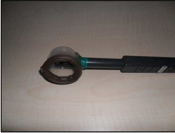
Şekil 4.2. Örnekleme aparatı ve içerisindeki Nem-sıcaklık sensörü
