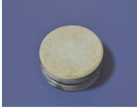
Şekil 7.55. HVOF tekniğiyle üretilen TBC'lerin termal çevrim/şok testi, 5000 çevrim/100 saat sonrasındaki makroyapı fotoğrafı
