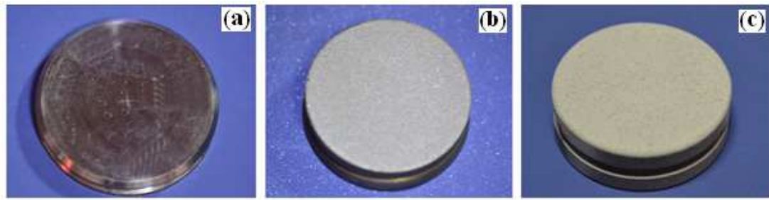
Şekil 6.13. Deneysel çalışmalarda kullanılan numunelerin makroyapı görüntüleri; a. kaplama prosesi öncesi, b. bağ kaplama üretimi sonrası, c. üst kaplama üretimi sonrası
