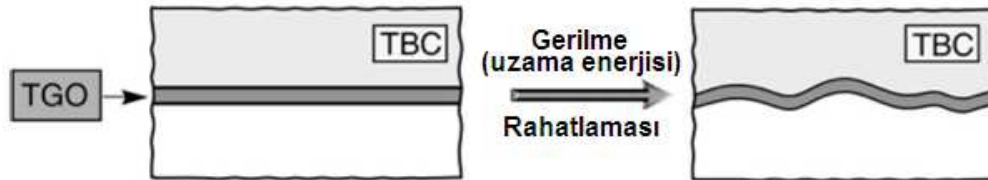
Şekil 3.15. TGO’da ki gerilme etkisiyle dalgalanma oluşumu [15].
