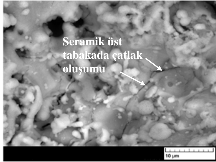
Şekil 7.60. HVOF-CoNiCrAlY bağ ve APS-YSZ üst kaplamaya sahip TBC numunesinin 5000 çevrim/100 saat termal çevrim/şok testi sonrası üst yüzey SEM mikroyapısı
