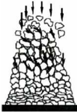
Şekil 2.9. CGDS prosesinde arkadan gelen parçacıkların neden olduğu deformasyon süreci [22].
