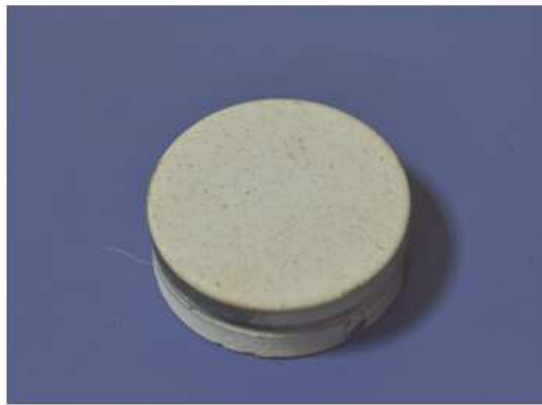
Şekil 7.49. APS tekniğiyle üretilen TBC'lerin termal çevrim/şok testi, 5000 çevrim/100 saat sonrasındaki makroyapı fotoğrafı
