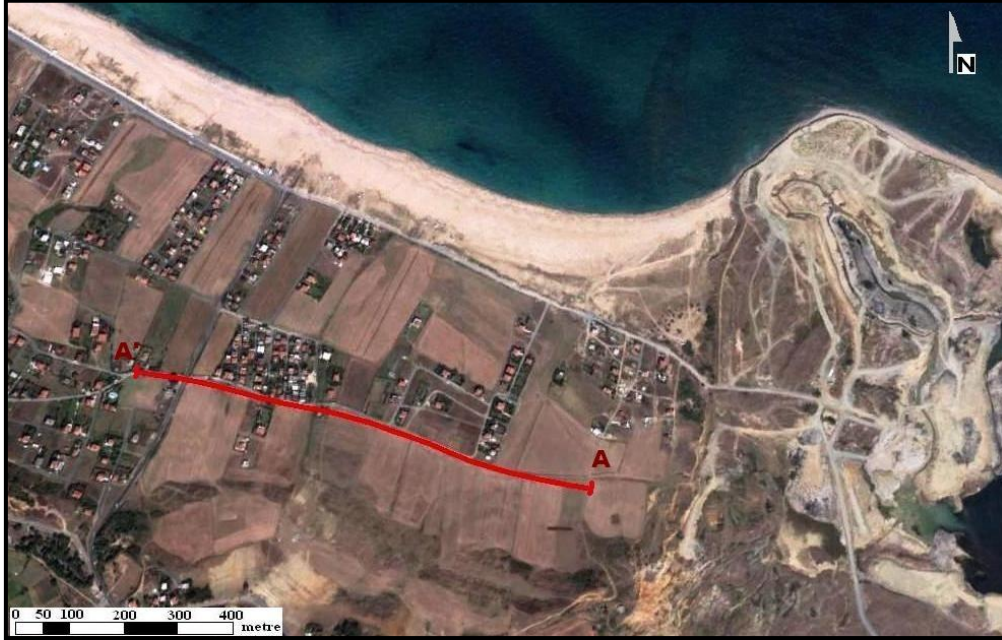
Şekil 5.5. Çalışmada kullanılan yüksek ayrımlı sığ sismik yansıma hattı (Kırmızı çizgi; sismik hat, A; sismik hattın başlangıç noktası ve A'; sismik hattın bitiş noktası) (Google Earth, 2012)
