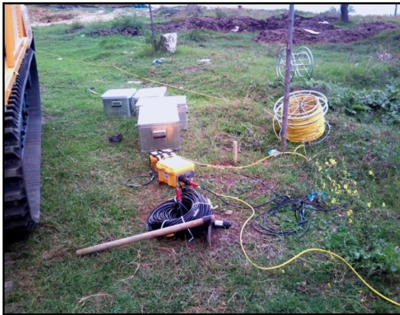
Şekil 5.8. Çalışmada kullanılan Geometrics – Geode sistem ve ekipmanları
