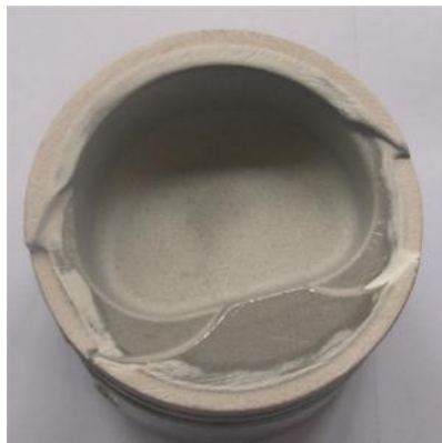
Şekil 4.14. Seramik kaplamalı pistonun görünüşü
