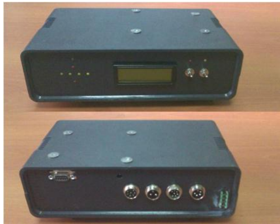
Şekil 4.3. EKBPS' de kullanılan mikro denetleyici ve kontrol devresini içeren kutu
