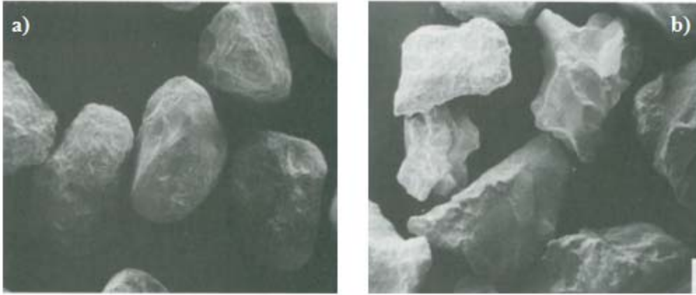
Şekil 3.27. Silis partiküllerinin TEM görüntüleri: a) Yuvarlatılmış b) Köşeli (Hutchings, 1992)
