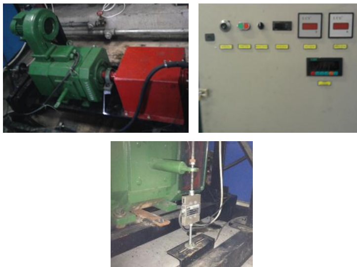
Şekil 3.4. Deneylerde kullanılan dinamometre, dinamometre kontrol panosu ve loadcell
