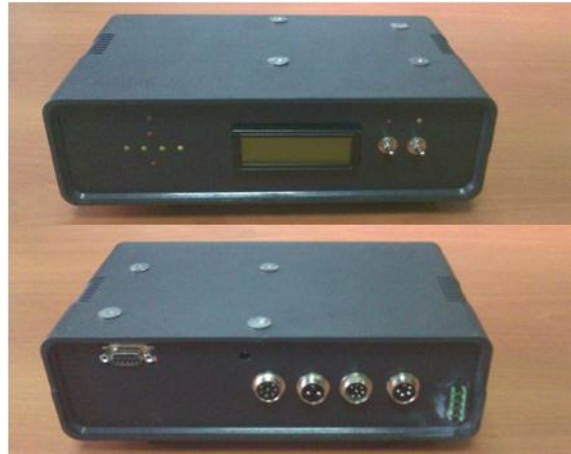
Şekil 3.19. EKBPS’de kullanılan mikrodenetleyici ve kontrol devresini içeren kutu
