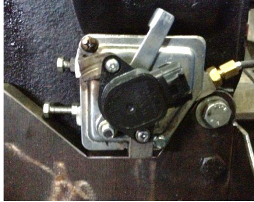
Şekil 3.25. Gaz kolu potansiyometresinin motor üzerine konumlandırılması
