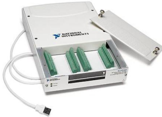
Şekil 3.16. DAQ kart, NI USB-6251 Mass Term [79]
