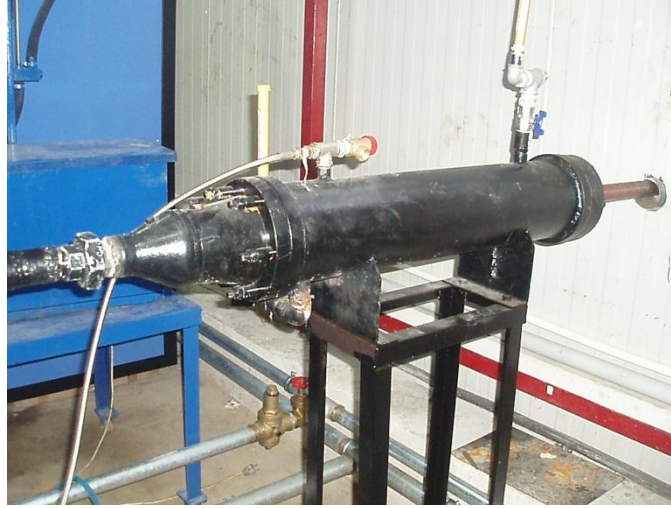
Şekil 3.27. Atık ısı kazanı ve üzerindeki ekipmanlar
