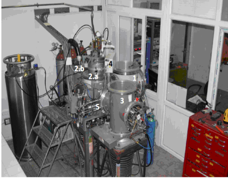
Şekil 3.2. HAKC-T’nin resmi. Helyum demet odacığı (1), kırınım odacığı (2a), pompalama odacığı (2b), organik kaynak demet odacığı (3), kuadrupol kütle spektrometresi (4), kuartz kristal mikro terazi (5)
