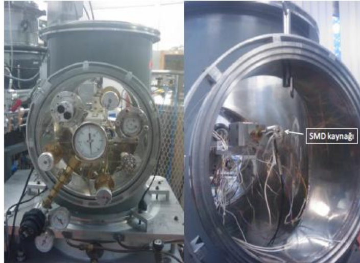
Şekil 3.4. Organik demet kaynak odacıđını süpersonik moleküler demet kaynađı (SMD) ile beraber gösteren resmi
