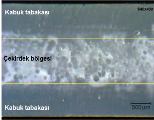
Şekil 6.39. Enjeksiyon kalıplama ile mikrohüresel köpüklü parçalarda sandviç modeli [175]
