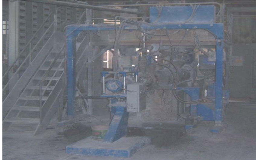
Şekil 3.10. ”Werner &Pfleider GmbH. ZSK 25” çift vidalı ekstrüder
