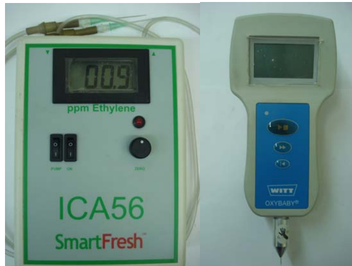
Şekil 3.2. Test düzeneğinde kullanılan ICA56 etilen analizatörü ile Oxbaby oksijen/karbondioksit analizatörü
