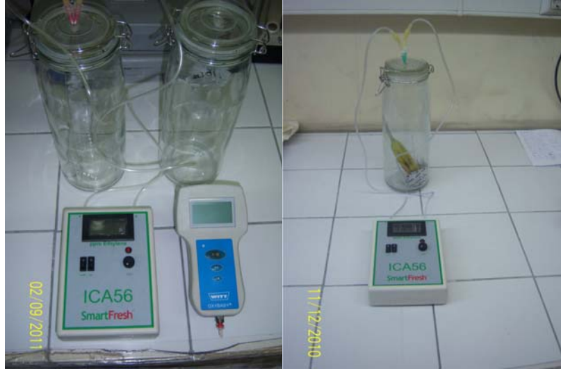
Şekil 3.1. Zeolit türlerinin, etilen ve karbondioksit gazlarını adsorplayabilme yeteneklerini tespit edildiği test düzeneği
