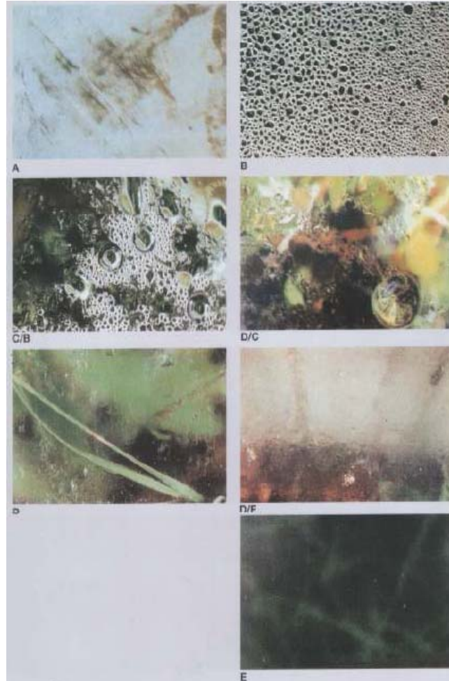
Şekil 3.8. Plastik filmlerin, buğu önleyici özelliklerinin derecelendirilmesi için kullanılan değerlendirme ölçütleri
