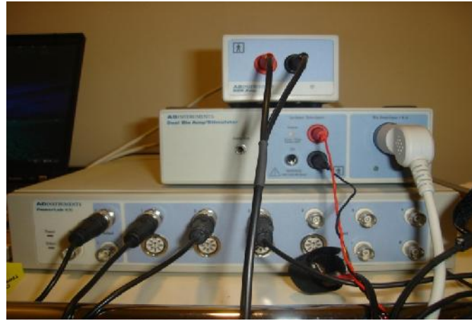
Şekil 2.1b. SSR ölçüm sisteminin bağlantı şekli
