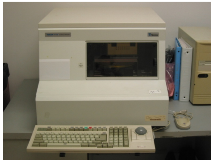
Şekil 6.2. KLA Tencor P-10 temassız yüzey profilometresi.
