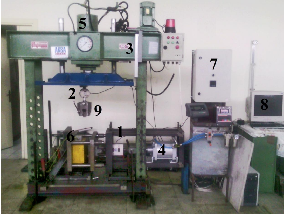
Şekil 3.2. Modernize edilmiş 100 tonluk atölye tipi pres
