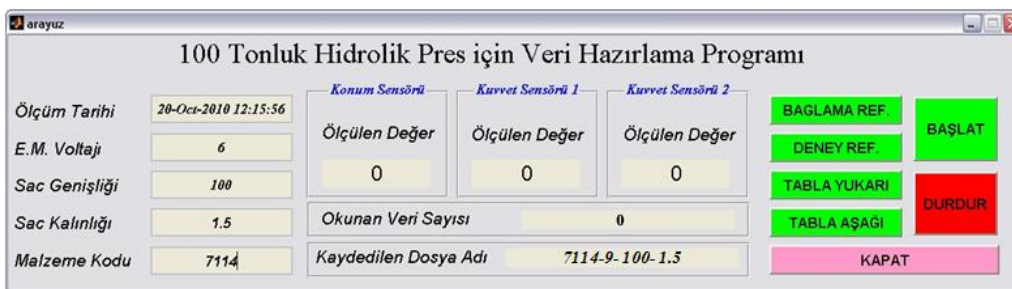
Şekil 3.4. Pres üst tablasının konumu ayarlayan ve yük hücrelerinde gelen bilgileri kaydeden arayüz
