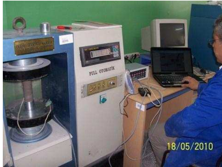
Şekil 4.13 Tek eksenli basınç deney cihazı (Çelik makine 200 ton kapasiteli)
