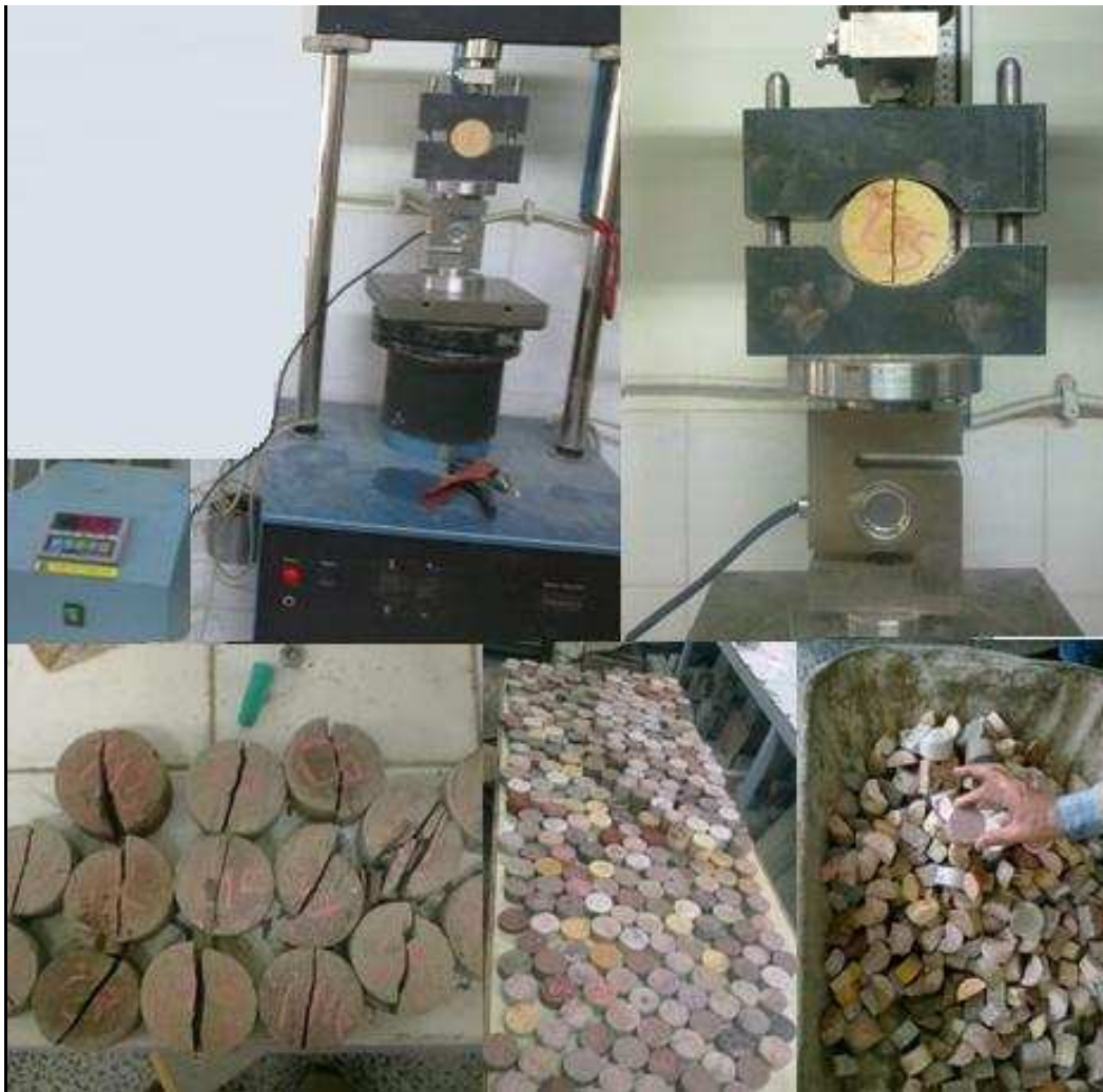
Şekil 4.16. Brazillian deney düzeneği ile test öncesi ve sonrası örnekler
