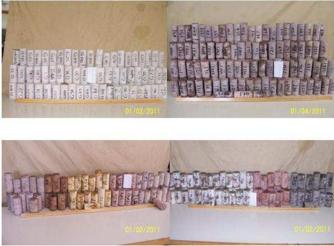
Şekil 4.4. Kayseri tüflerinden elde edilen, çeşitli çap ve boylardaki silindir numuneler (Gesi, Ağırnas, Talas, İncesu ve Tomarza)
