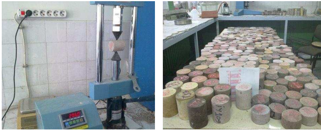
Şekil 4.18. Nokta yükleme deney aleti ile eksenel ve çapsal tuf örnekleri
