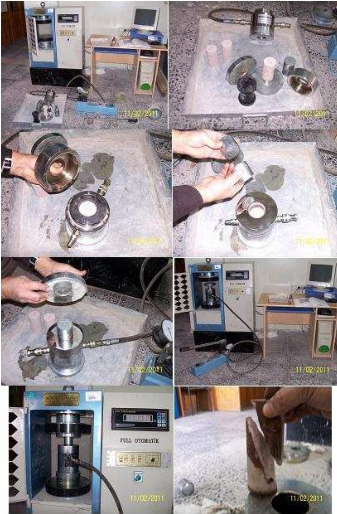
Şekil 4.15. Kayseri Tüflerinin üç eksenli basınç deneyi aşamaları
