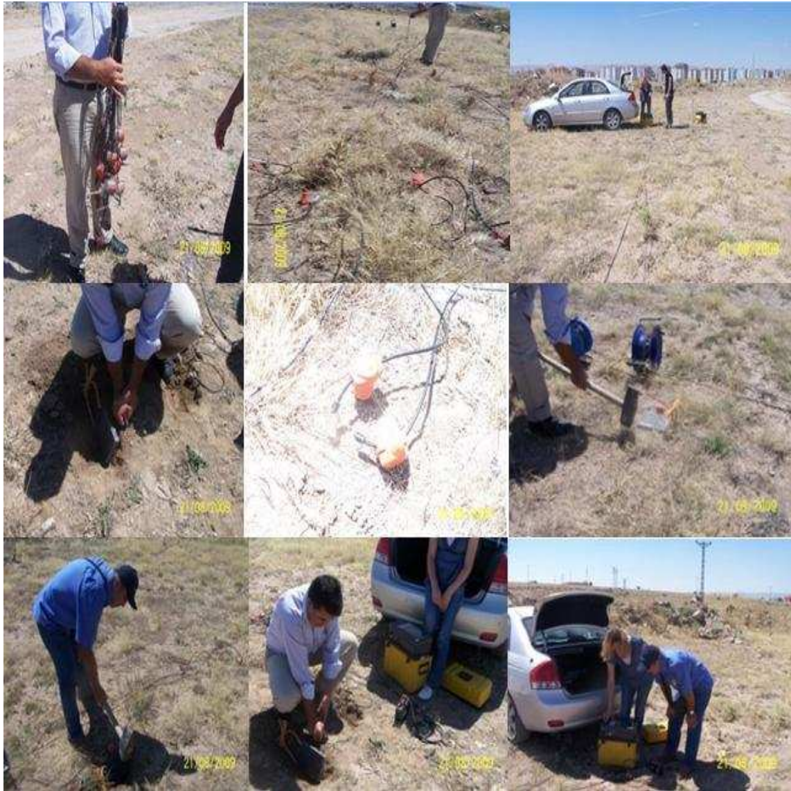
Şekil 4.21. Geometrics ES-3000 marka 12 kanallı sismik kırılma ve yansıma cihazı ile arazide sismik ölçüm
