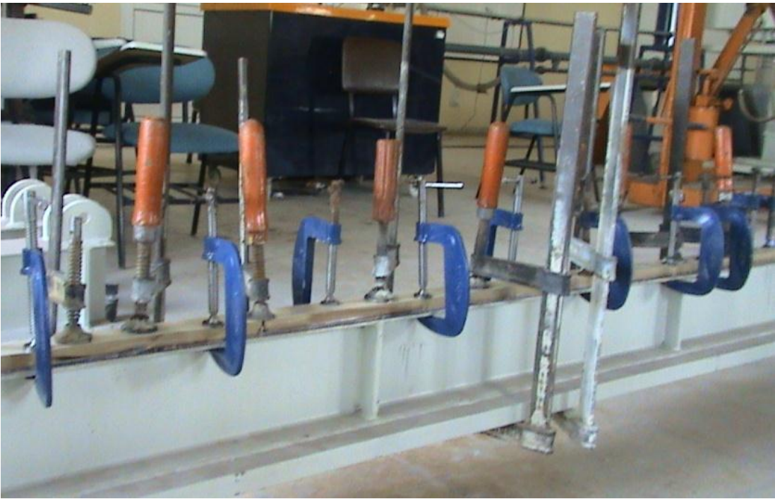
Şekil 3.18. HM-CFRP'nin mengenerlerle sabitlenmesi
