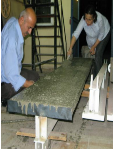
a) Betonun saç kalıba yerleştirilmesi
