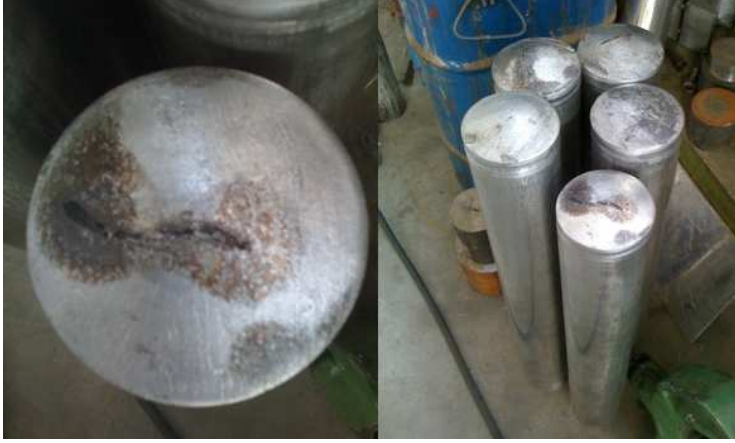
Şekil 2.7. Çatlak-iç boşlukların görünüşü
