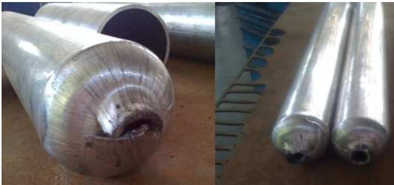
Şekil 2.8. Yırtılma ve kapanma probleminin görünüşü
