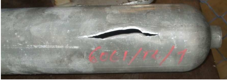
Şekil 3.8. AA6061 T6 prototipinin hidrostatik basınç testinden sonraki görünümü
