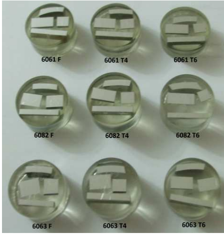
Şekil 3.11. Mikroyapı incelemeleri için hazırlanan numuneler
