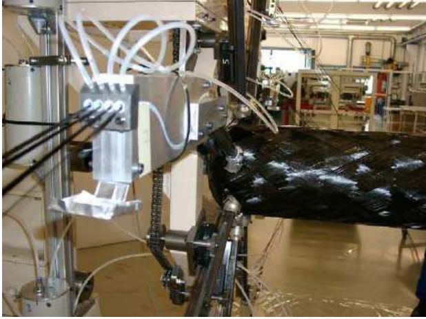
Şekil 1.24. Alüminyum tank üzerine karbon lifi takviyesinin sarılması [91]
