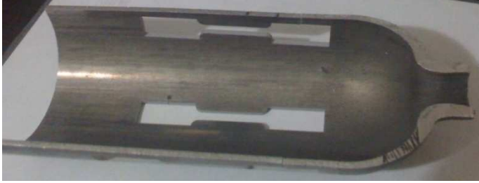
Şekil 3.4. Çekme testleri için numunelerin çıkarıldığı tüp kesiti
