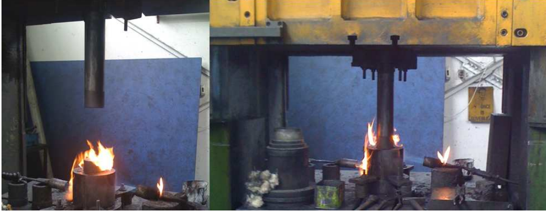
Şekil 2.1. Hidrolik pres yardımıyla içi dolu silindirden içi boş kap şeklinde silindir elde edilmesi [98]
