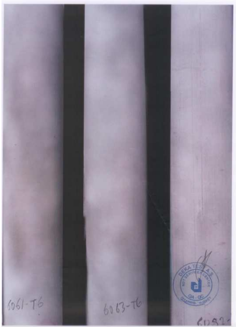
Şekil 3.28. AA6061 T6 - AA6063 T6 – AA6082 T6 tanklarına ait penetrant testleri görünüşleri
