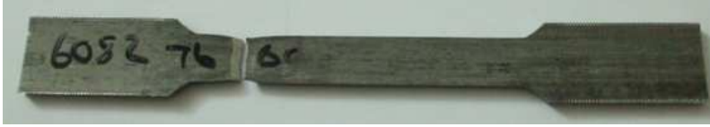
Şekil 3.6. Çekme işlemi tamamlanmış test numunesi
