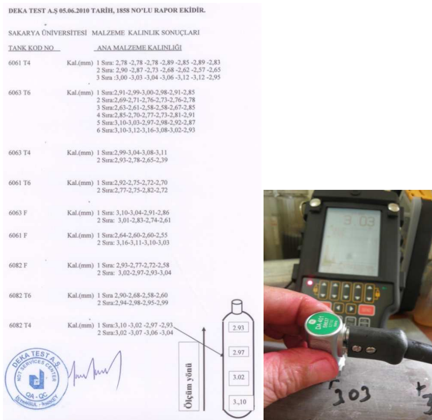
Şekil 3.31. Kesitte ultrasonik kalınlık ölçüm sonuçları
