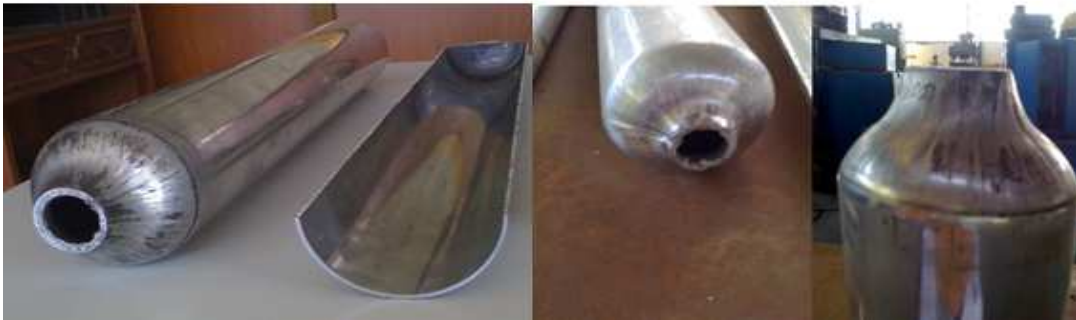
Şekil 2.4. Alüminyum hidrojen tankın uç kısmını büzme işlemi
