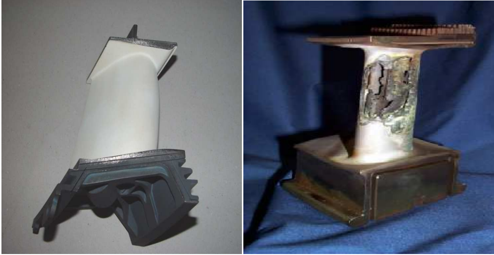
Şekil 1.11. Kullanım öncesi ve kullanım sonrası kanatçıktaki TBK görüntüsü
