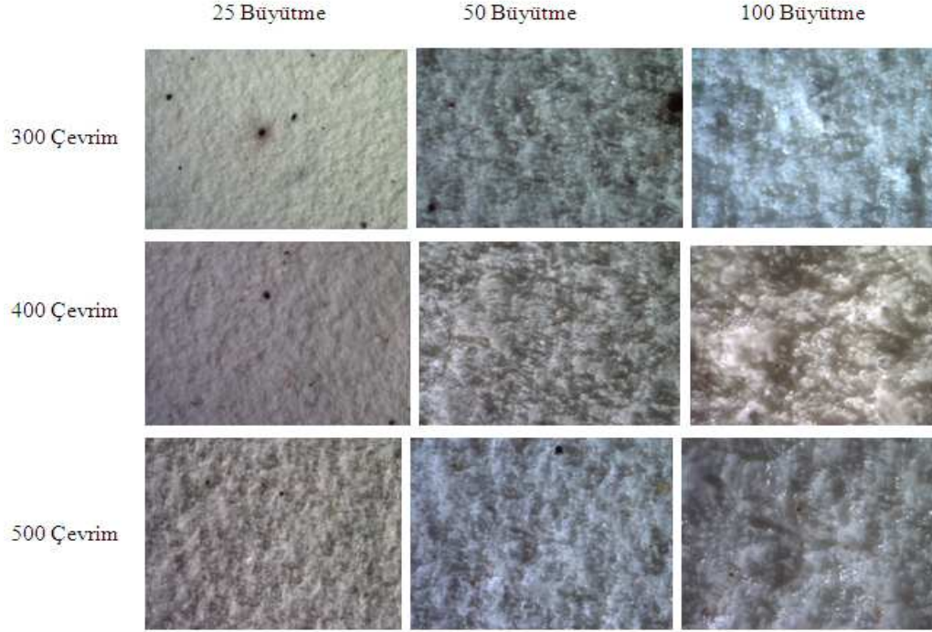
Şekil 3.11 Deney numunesinin 300 çevrim 400 çevrim, 500 çevrim sonundaki optik mikroskop yüzey görüntüleri
