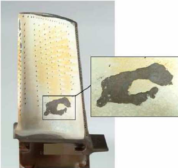
Şekil 1.10 .Termal bariyer kaplamalarda rastlanan tipik bir servis hasarı [27]
