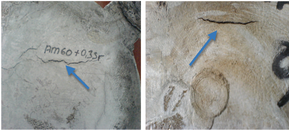
Şekil 4.2. Deneme döküm görüntüleri (ok ile gösterilen sıcak yırtılma).
