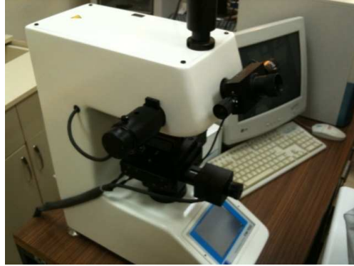
Şekil 5.18. Sertlik ve kırılma tokluğu ölçümlerinin yapıldığı mikrosertlik cihazı
