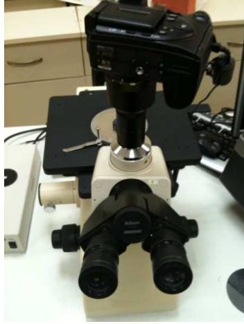
Şekil 5.12. Optik mikroyapı incelemelerinde kullanılan mikroskop
