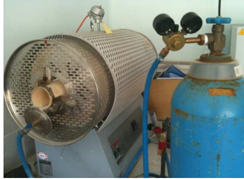
Şekil 5.11. Isıl işlemde kullanılan Protherm tüp fırını
