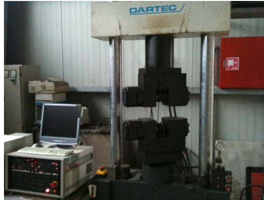
Şekil 5.15. Yapışma mukavemeti testlerinin gerçekleştirildiği DARTEC çekme cihazı
