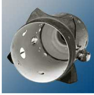
Şekil 3.12. Atmosferik plazma sprej yöntemi ile kaplanmış jet motor parçası (basınçlı hava ve yakıtın yanma odasına ait) [62]
