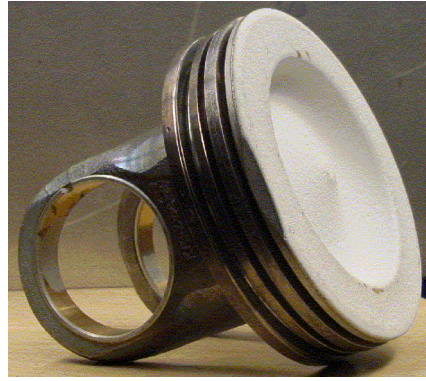
Şekil 3.11. Plazma sprej tekniği ile zirkonya (YSZ) kaplanmış dizel motor pistonu [76]
