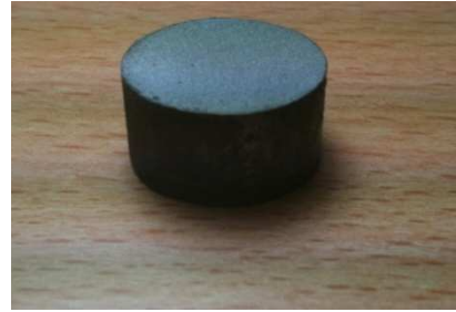
Şekil 5.7. Deneysel çalışmalarda altlık olarak kullanılan AISI 1040 çelik numunelerin şekil ve boyutları
