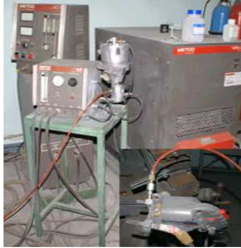
Şekil 5.8. METCO 3M Metco Perkin Elmer, 3MB II atmosferik plazma sprey kaplama ünitesi (Sakarya Üniversitesi)
