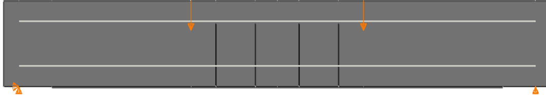
b) Çatlak yüksekliği 0.75xh olan 90 mm aralıklı ve 1 mm genişliğindeki çatlak görünümü
