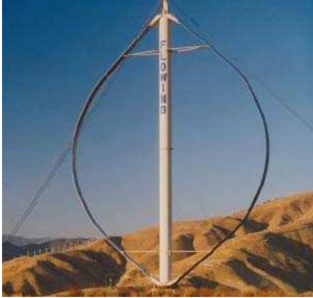
Şekil 3.17. Darrieus tipi düşey eksenli rüzgar türbini [76]
