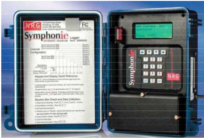
Şekil 3.9. Veri toplayıcı (Data Logger) [61]
