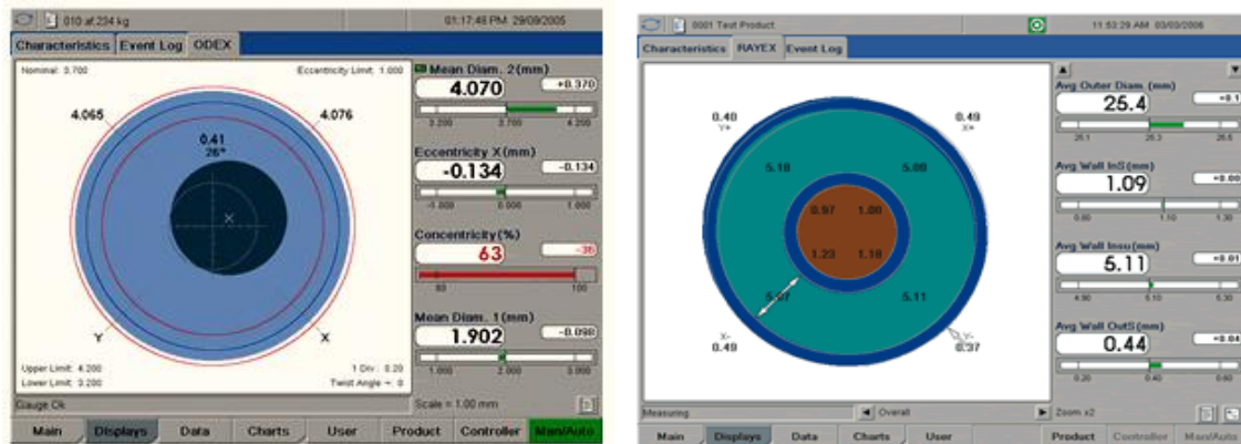
Şekil 3.6. Endüstriyel kalınlık ölçme display örnekleri ( deney-microsoft computer EL-Kİ A.Ş.) [7]
