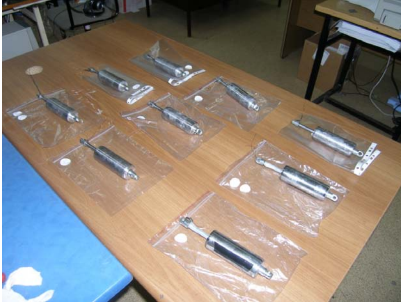
Şekil 8.6. İmal edilen MR damperlerin montaj sonrası görüntüsü
