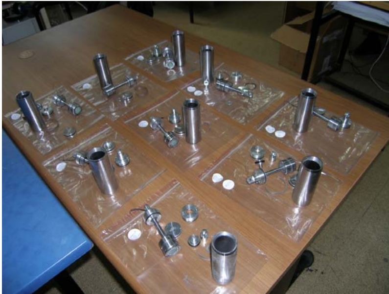
Şekil 8.5. İmal edilen MR damperlerin montaj öncesi görüntüsü
