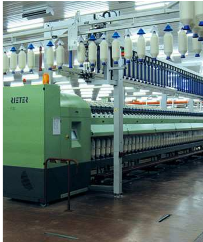
Şekil 3.9. Kesik elyaf iplik üretim makinesi ( ring )
