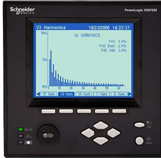
Şekil 4.2. ION 7650 Enerji analizörü
