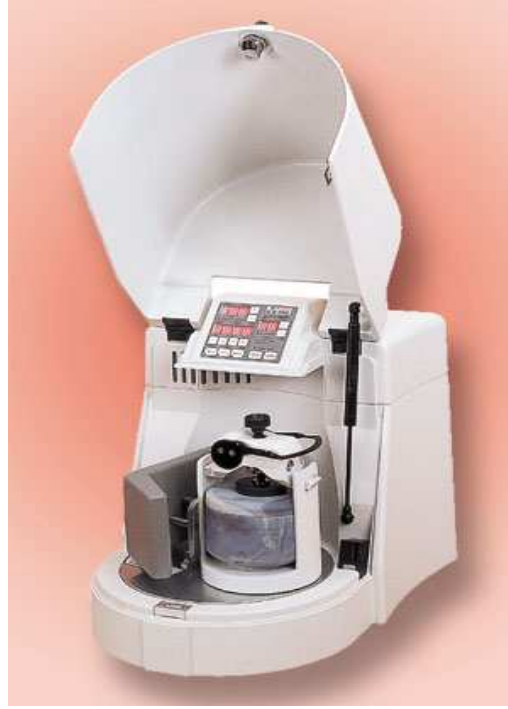
Şekil 5.1. Deneysel çalışmalarda kullanılan gezegensel değirmen
