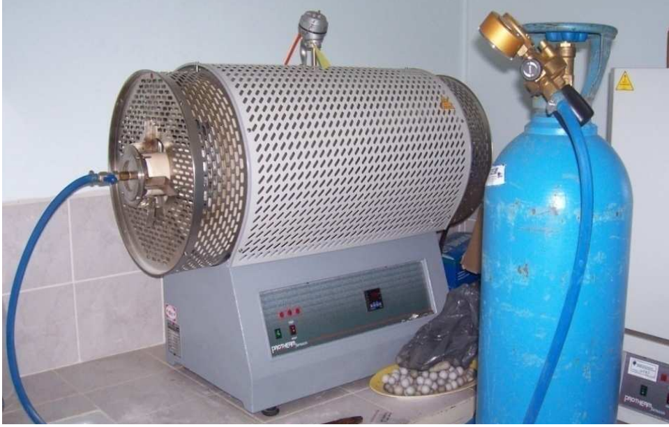
Şekil 5.2. Redüksiyon çalışmalarında kullanılan tüp fırın (maksimum 1600°C)
