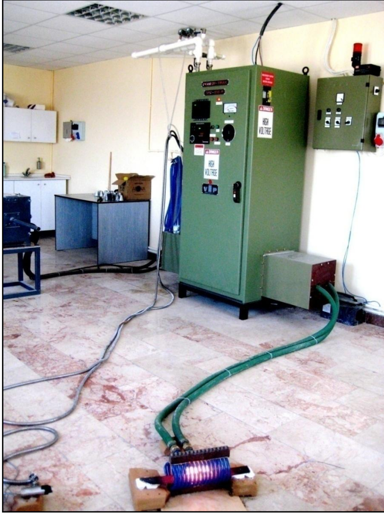
Şekil 3.2. İndüksiyon ergitme sistemi (güç ünitesi ve ısıtma bobini)
