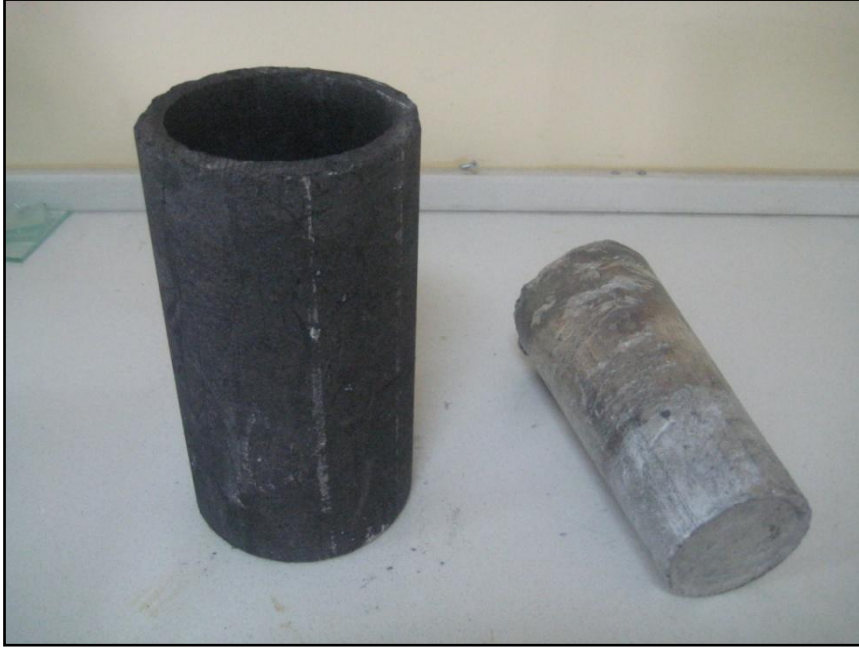
Şekil 3.12. Doğrudan döküm yönteminde kullanılan grafit pota ve döküm sonrası üretilmiş AlB_2 kompozit külçesi
