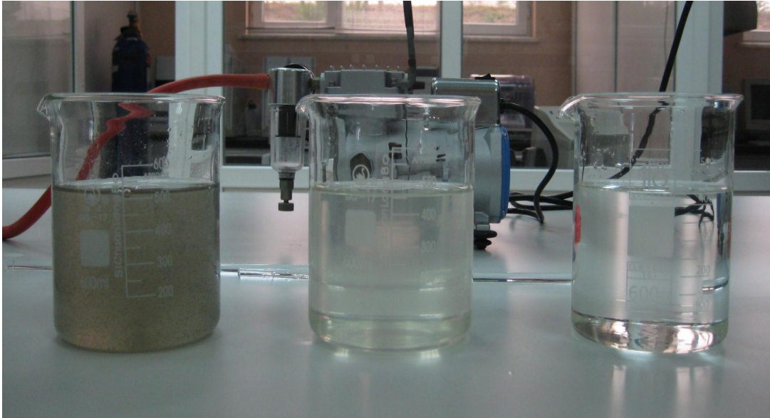
Şekil 5.23. Tübüler membran biyoreaktör giriş ve çıkış suyu kalitelerinin karşılaştırılması
