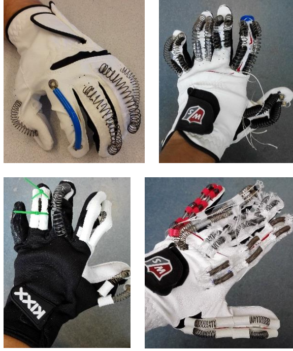
Şekil 5.8. Yayların eldiven üzerine yerleşimi için yapılan farklı denemeler
