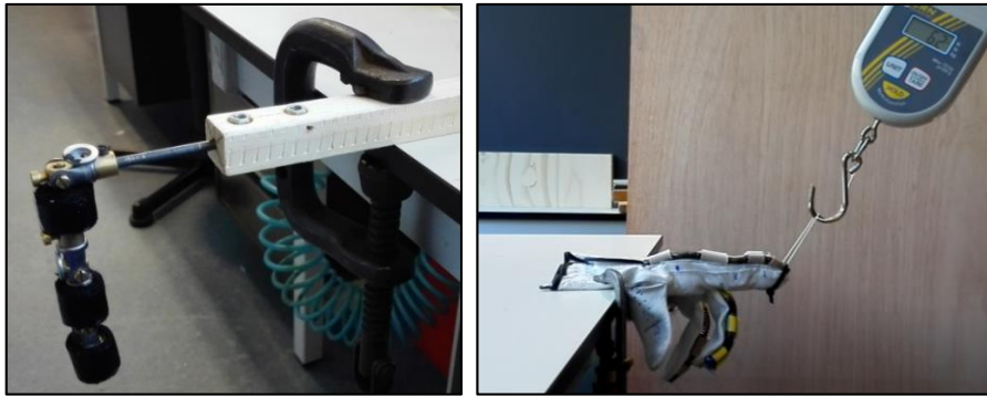
Şekil 5.10. Kuvvet ölçümü için hazırlanan test düzeneği. Solda; işaret parmağı modeli, sağda; kuvvet ölçümü
