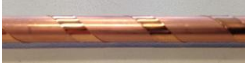
Şekil 3.9. Tek şerit ile sarılmış CORC kablo
