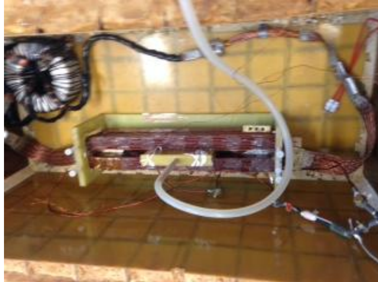
Şekil 5.36. AA/AA kayıplarını ölçmek için kullanılan sistem
