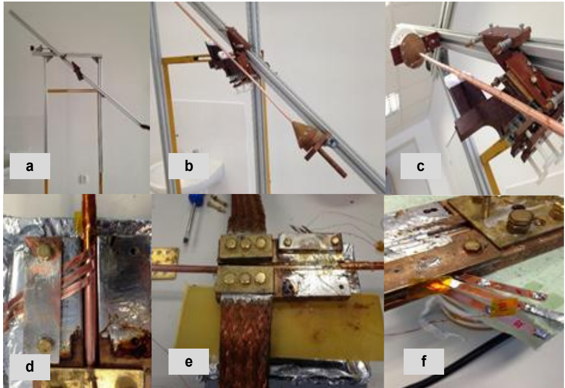
Şekil 5.14. CORC kablo yapım adımları
