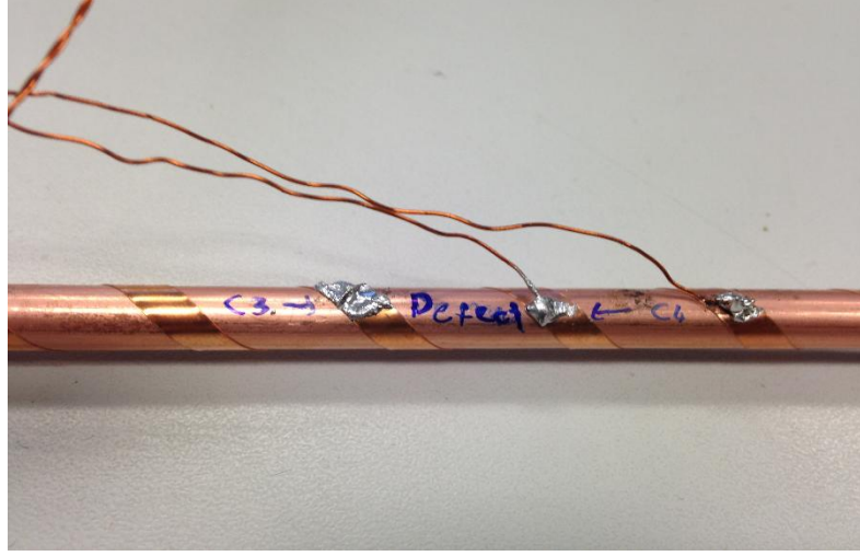
Şekil Ek-2.5. Kablonun zarar görmüş bölgesi.
