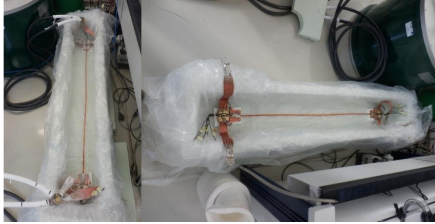
Şekil 5.17. Kablo kritik akım ölçümü için hazırlanan soğutma bölgesi
