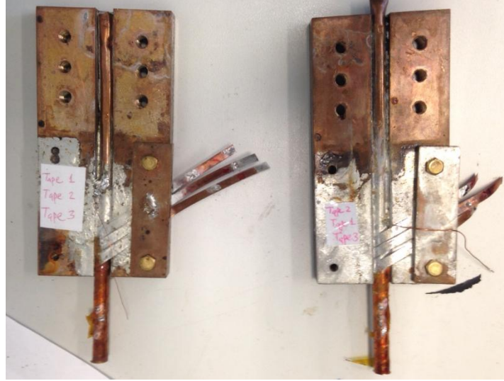
Şekil 5.21. CORC kablunun uçlarından kesilen 6 cm'lik parçalar
