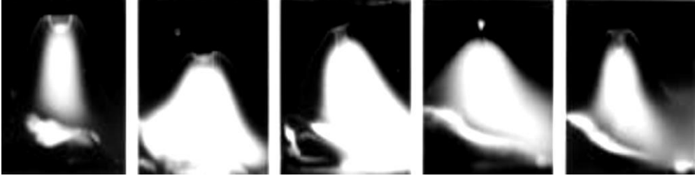
Şekil 4.9. Darbeli ark yönteminde elektrodun erimesi
