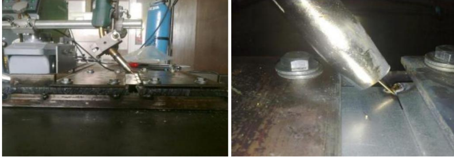
Şekil 5.2. MIG-lehimleme işleminin yapıldığı makine ve sekator
