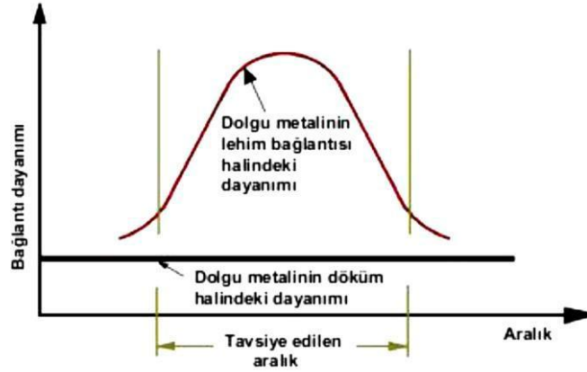
Şekil 4.3. Bağlantı açıklığının fonksiyonu olarak bağlantı dayanımı
