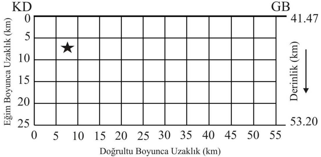
Şekil 3.47. 16 Mayıs 1999 Yeni Britanya depreminin ters çözümü için kullanılan sonlu-fay modeli. Modelde fay düzlemi 5 km aralıklarla toplam 55 adet fay parçasına bölünmüştür. Model üzerinde bulunan yıldız depremin odağını temsil etmektedir. Gösterimdeki odağın üst, KD ve GB kenarlara olan uzaklıkları (sırasıyla 7.5 km, 7.5 km ve 47.5 km) ters çözüm denemeleri sonucunda elde edilmiş olup başlangıç değerlerinden farklı olabilecekleri hatırlatılmalıdır
