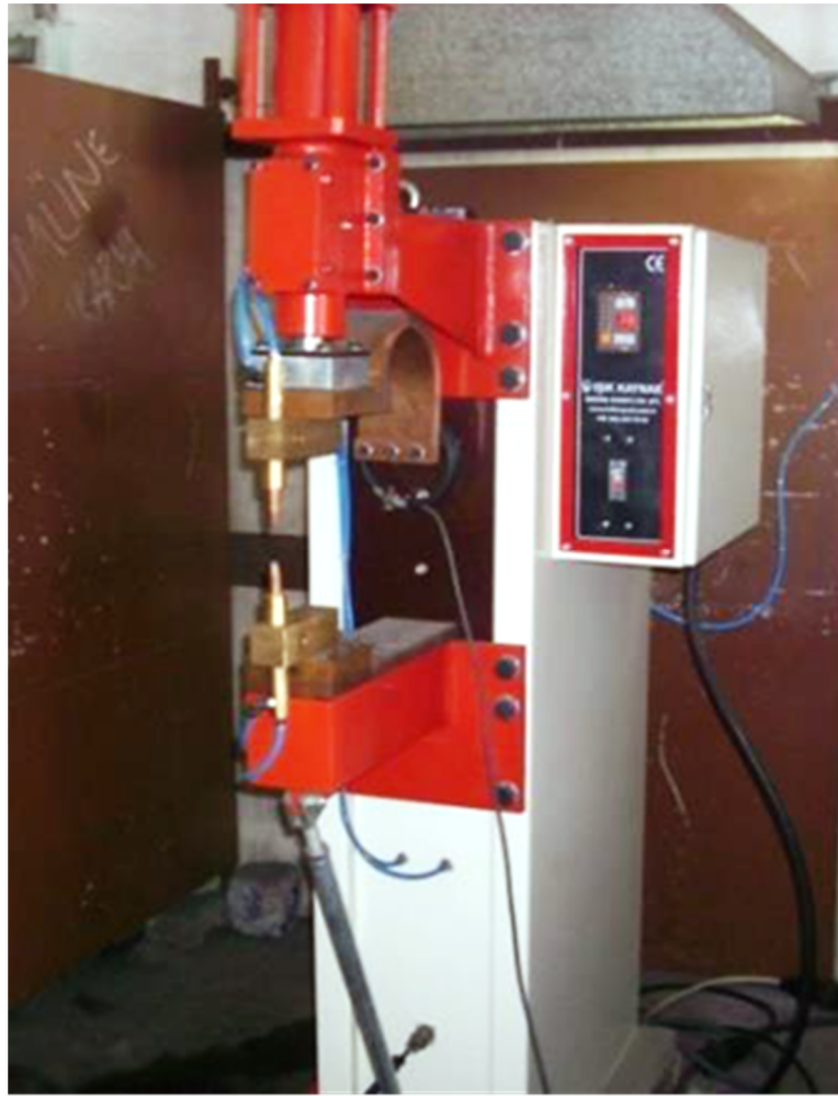
Őekil 7.4. Elektrik direnç nokta kaynak makinesi
