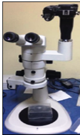
Şekil 7.14. Çekirdek boyutu ölçümünde kullanılan optik mikroskop
