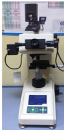
Şekil 7.17. Mikro sertlik ölçüm cihazı
