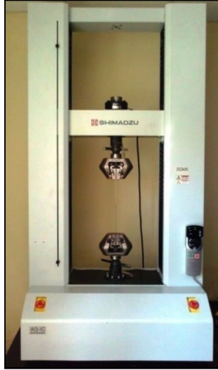
Şekil 7.13. Deneyleerde kullanılan 5 tonluk çekme – basma cihazı
