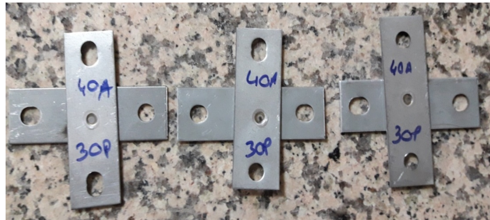
Şekil 7.11. Çapraz çekme deney numuneleri
