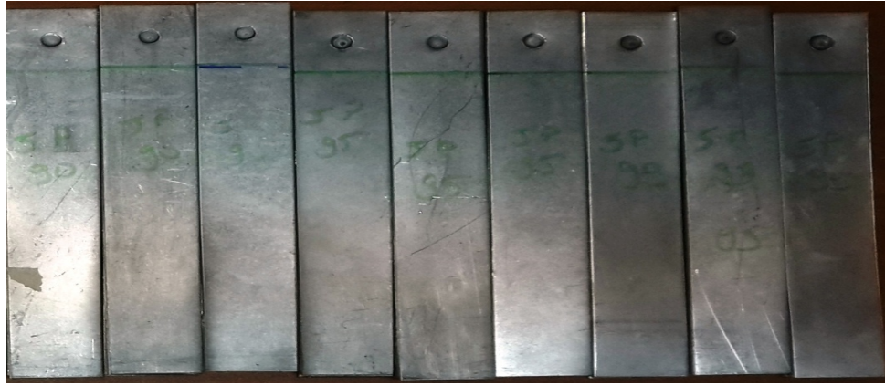
Şekil 7.10. Çekme – Sıyırma deney numuneleri
