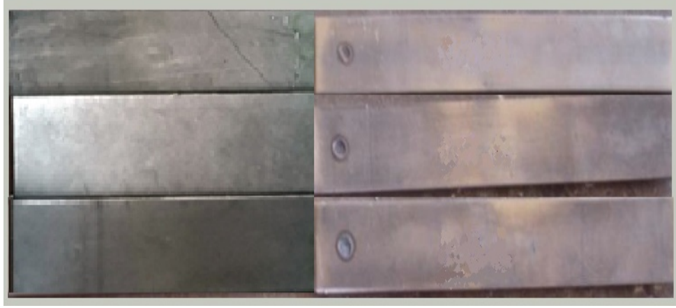
Şekil 7.9. Çekme – Makaslama deney numuneleri
