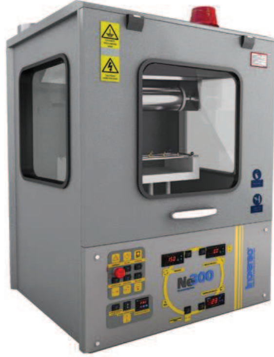
Şekil 3.1. Çalışmada kullanılan elektron eğirme cihazının fotoğrafı.
