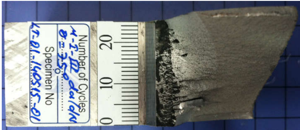
Şekil 3.27. Mod-I/III 75° yüklemeye açısında, 25 mm kalınlıđa sahip CTT numunesi için yapılan çatlak ilerleme deneyi sonrasında kırılan numune yüzeyinin görünümü.
