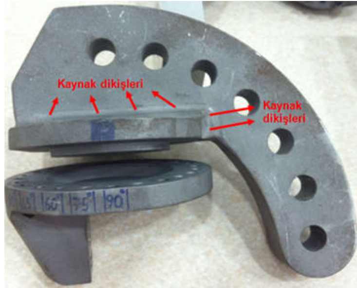
Şekil 2.109. Mod-I/II/III CTST numune tutucusunun mod-II/III yüklemesi yapabilmesi için tasarlanan ve kaynak işlemi ile tutucuya tutturulan aparat ve tutucunun yakın görünümü.
