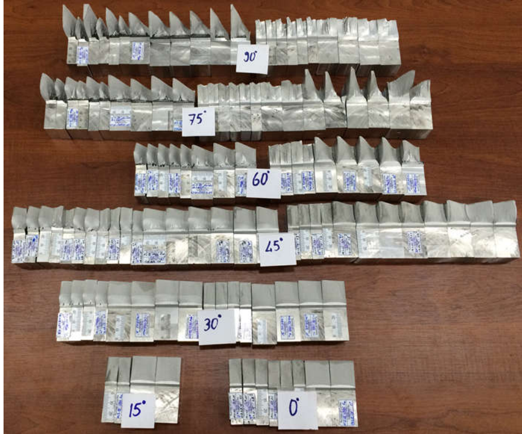
Şekil 2.77. Mod-I/III ve mod-II/III testlerinde kullanılan tüm numuneler (üst görünüş).
