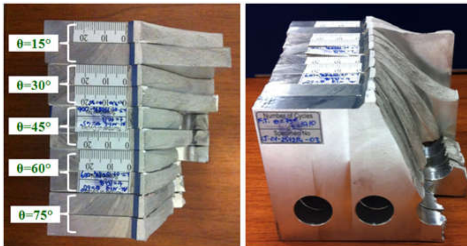
Şekil 2.37. Farklı açılarda kırılan numune yüzeylerinin perspektif görünümü.
