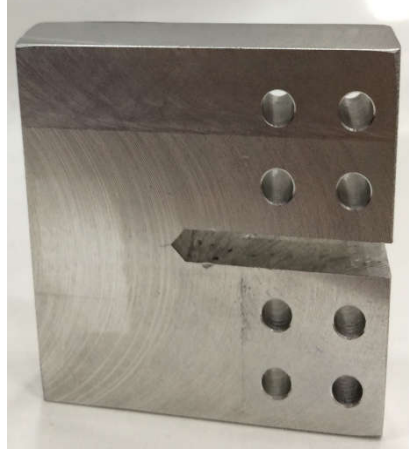
Şekil 2.71. 12,5 mm kalınlıktaki mod-I/III CTT numunesi.
