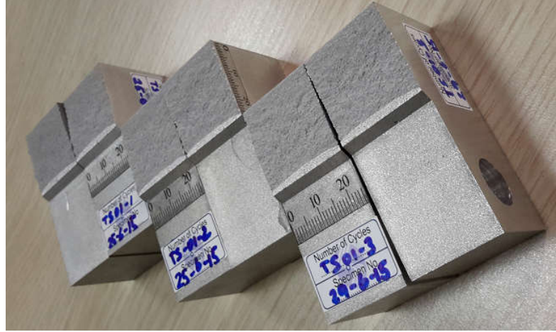
Şekil 5.2. TS hadde yönündeki CT numuneleri için gerçekleştirilen mod-I kırılma tokluğu testleri sonrası kırılan numune yüzeylerinin genel görünümü.
