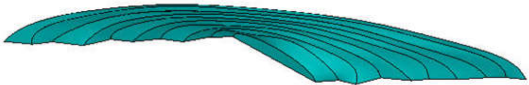
Şekil 4.12. Yatayla 30° açı yapan ön çatlığa sahip plaka için, geliştirilen kriterlere göre gerçekleştirilen çatlak ilerleme analizleri sonrası elde edilen çatlak yüzeyi.
