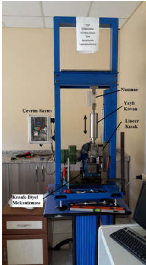
Şekil 2.7. Yorulma ön çatlakının oluşturulması için imal edilen yorulma cihazı.
