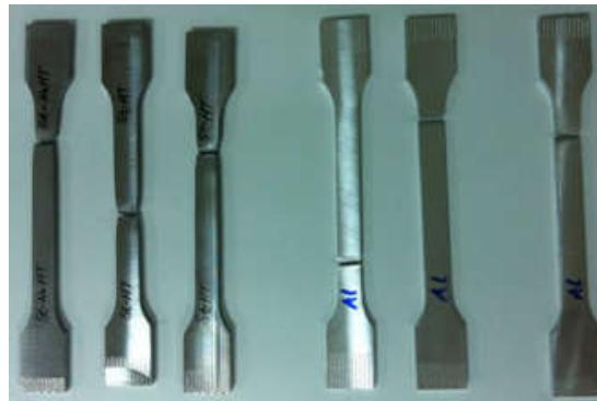
Şekil 2.6. Çekme testi sonrası alüminyum ve çelik malzemelerinin görünüşü.
