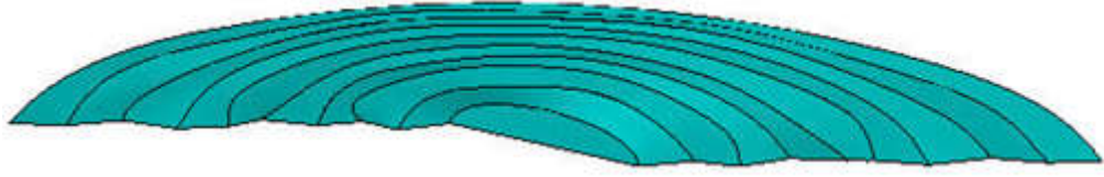
Şekil 4.9. Yatayla 15° açı yapan ön çatlığa sahip plaka için, geliştirilen kriterlere göre gerçekleştirilen çatlak ilerleme analizleri sonrası elde edilen çatlak yüzeyi.
