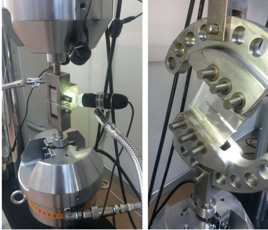
Şekil 5.1. CT ve CTS numuneleri için gerçekleştirilen kırılma tokluğu testlerinden bir kesit.
