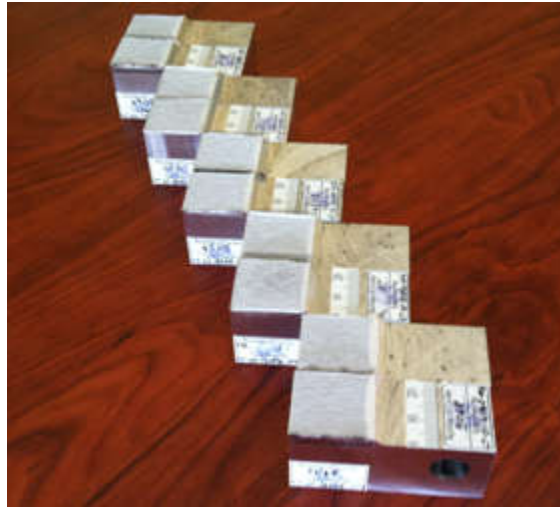
Şekil 2.11. Kırılma tokluğu testi sonucunda alüminyum malzemelerin perspektif görünüşü.
