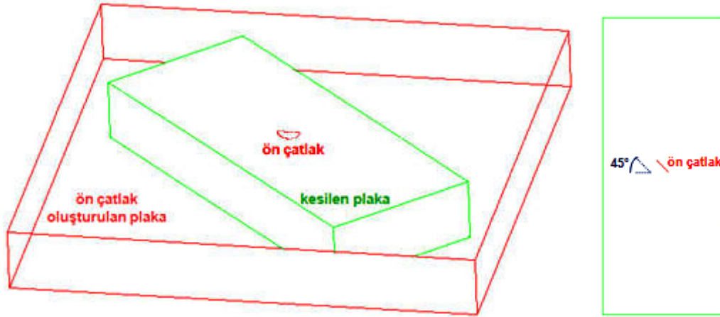
Şekil 4.6. Mod-I yüklemesi altında ön çatlak oluşturulmasının ardından belirli açılarda plakalar kesilerek çatlağın plaka kenarlarına açılı olarak yerleştirilmesinin sağlanması.
