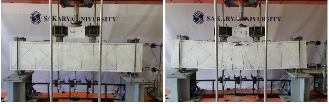
Şekil 7.7. SX400-1 kirişi deney öncesi ve deney sonrası
