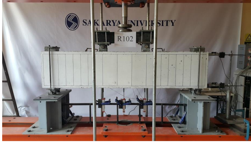
Őekil 5.17. Loadcell, analog ve dijital yer deęiřtirme ölçerler
