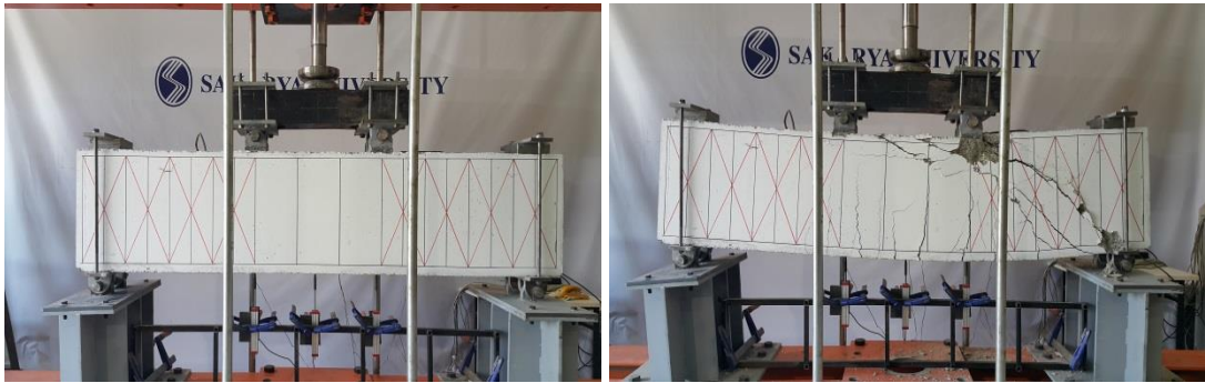
Şekil 7.39. S100X200-3 kirişi deney öncesi ve deney sonrası
