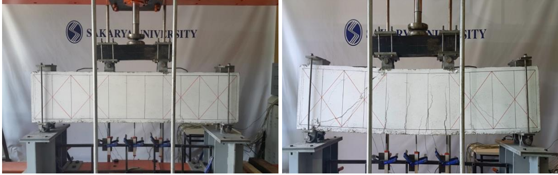
Şekil 7.36. S200X400-3 kirişi deney öncesi ve deney sonrası
