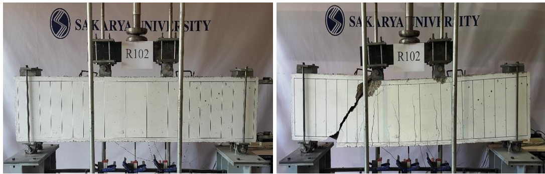
Şekil 7.18. R100-2 referans kirişi deney öncesi ve deney sonrası
