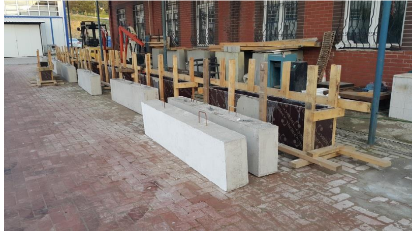
Şekil 5.7. Hazırlanmış deney numuneleri
