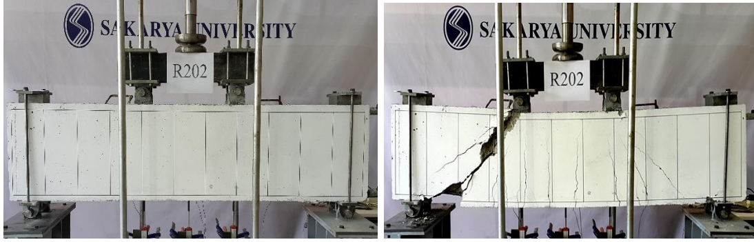
Şekil 7.20. S200-2 kirişi deney öncesi ve deney sonrası
