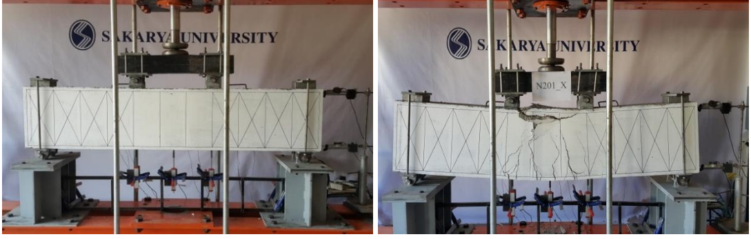
Şekil 7.4. SX200-1 kirişi deney öncesi ve deney sonrası
