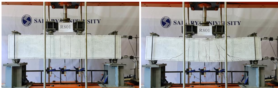
Şekil 7.9. S800-1 kirişi deney öncesi ve deney sonrası
