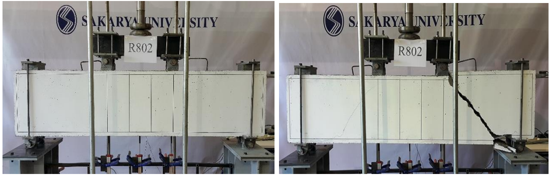
Şekil 7.26. S800-2 kirişi deney öncesi ve deney sonrası
