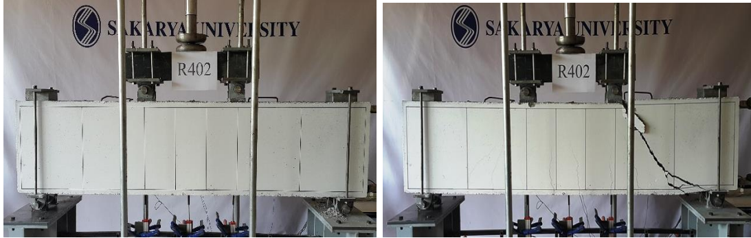
Şekil 7.23. S400-2 kirişi deney öncesi ve deney sonrası
