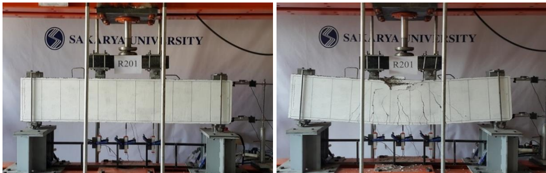
Şekil 7.3. S200-1 kirişi deney öncesi ve deney sonrası
