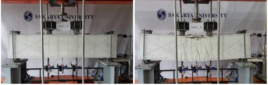
Şekil 7.10. SX800-1 kirişi deney öncesi ve deney sonrası
