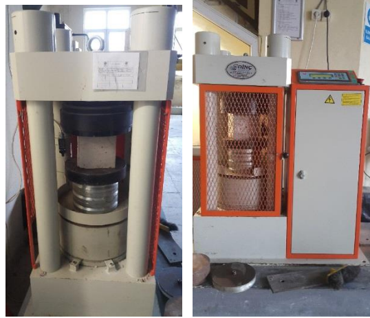
Şekil 5.8. Beton basınç deneyleri
