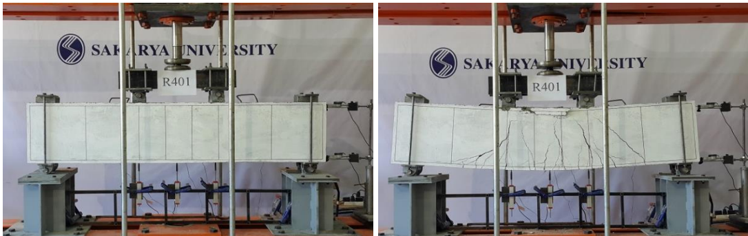
Şekil 7.6. R400-1 kirişi deney öncesi ve deney sonrası
