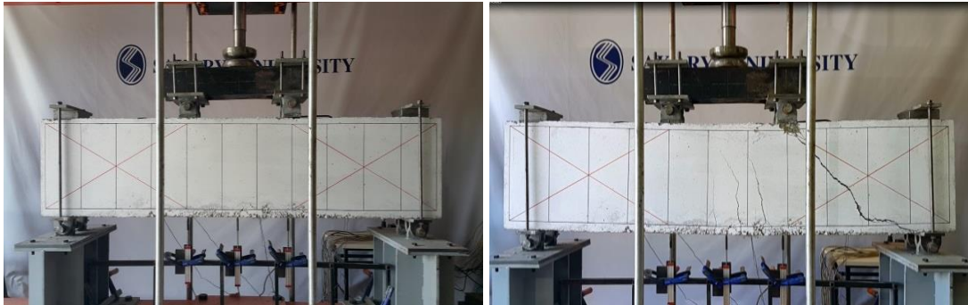
Şekil 7.37. S200X800-3 kirişi deney öncesi ve deney sonrası
