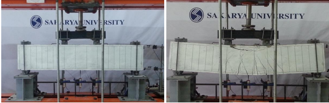
Şekil 7.1. R100-1 referans kirişi deney öncesi ve deney sonrası
