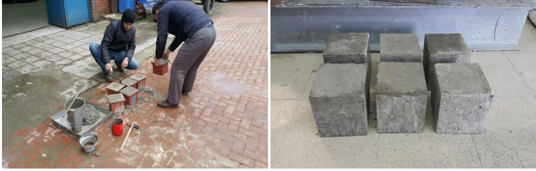
Şekil 5.6. Küp numune alımı
